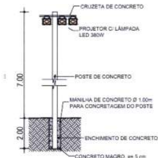
Figura 03-- Vista frontal do sistema de iluminação em LED
