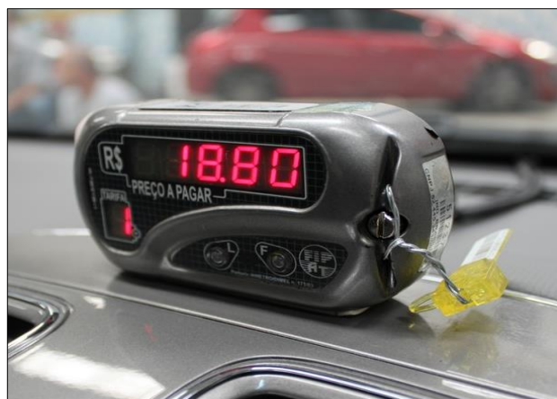
IMAGEM 7 – Verificação metrológica de taxímetro.
