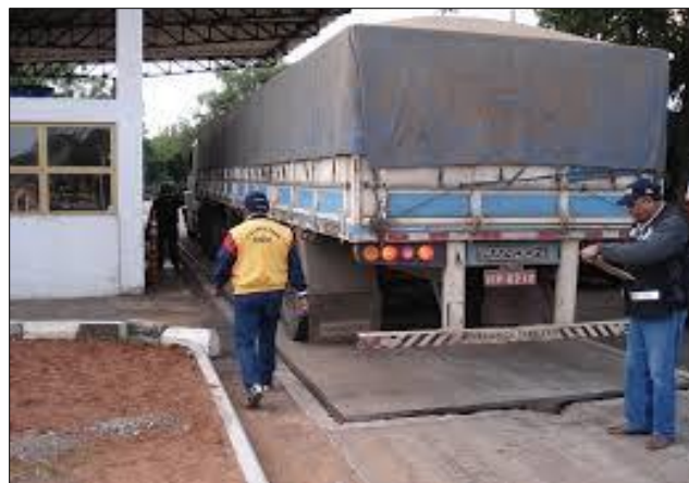
IMAGEM 3 – Uso de balança rodoviária em instalação industrial.
