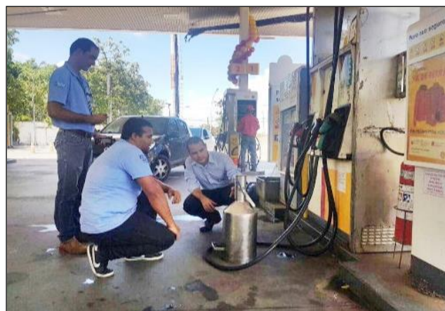
IMAGEM 1 – Atividade de verificação metrológica de bomba medidora de combustível.
