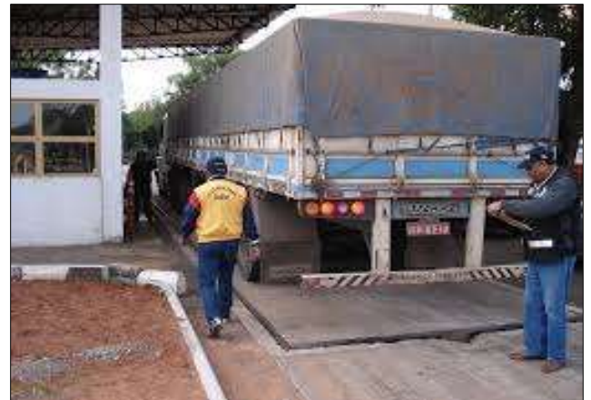
IMAGEM 3 – Uso de balança rodoviária em instalação industrial.
