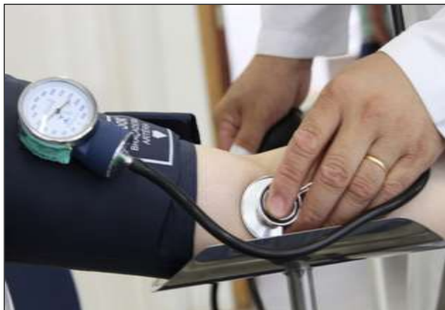
IMAGEM 5 – Verificação metrológica de esfigmomanômetro do tipo aneróide.
