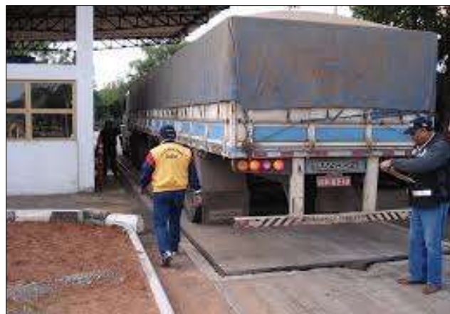
IMAGEM 3 – Uso de balança rodoviária em instalação industrial.
