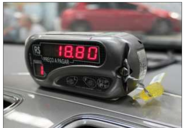
IMAGEM 7 – Verificação metrológica de taxímetro.
