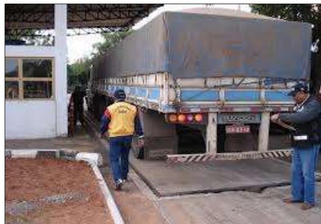
IMAGEM 3 – Uso de balança rodoviária em instalação industrial.
