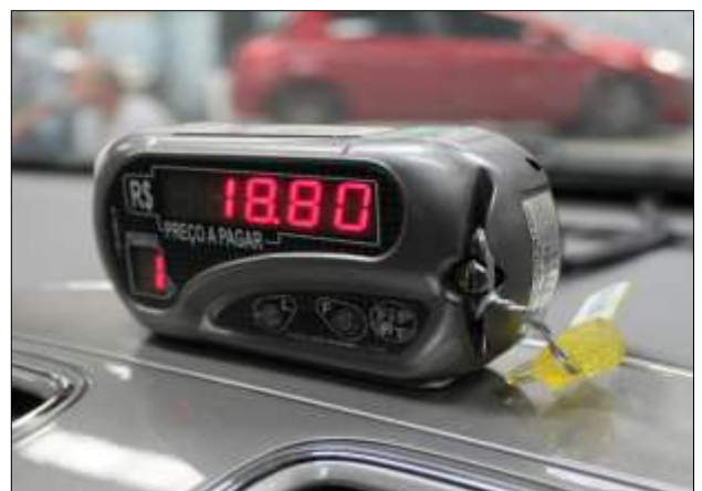
IMAGEM 7 – Verificação metrológica de taxímetro.
