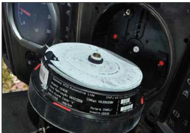
IMAGEM 4 – Validação da verificação do disco de registro de cronotacógrafo.
