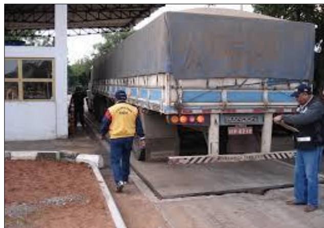
IMAGEM 3 – Uso de balança rodoviária em instalação industrial.
