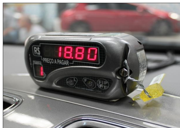
IMAGEM 7 – Verificação metrológica de taxímetro.
