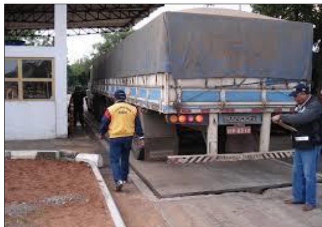
IMAGEM 3 – Uso de balança rodoviária em instalação industrial.
