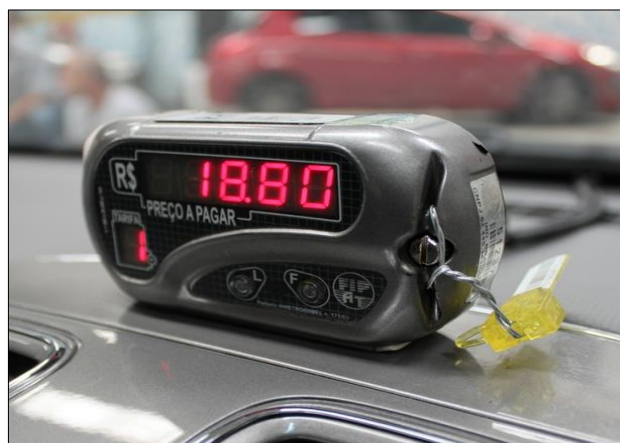
IMAGEM 7 – Verificação metrológica de taxímetro.
