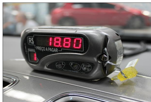
IMAGEM 7 – Verificação metrológica de taxímetro.
