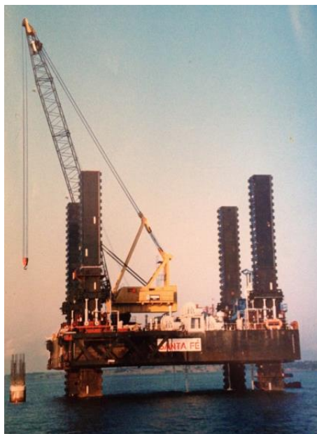
Fotografia 2 – Plataforma auto elevatória com guindaste
