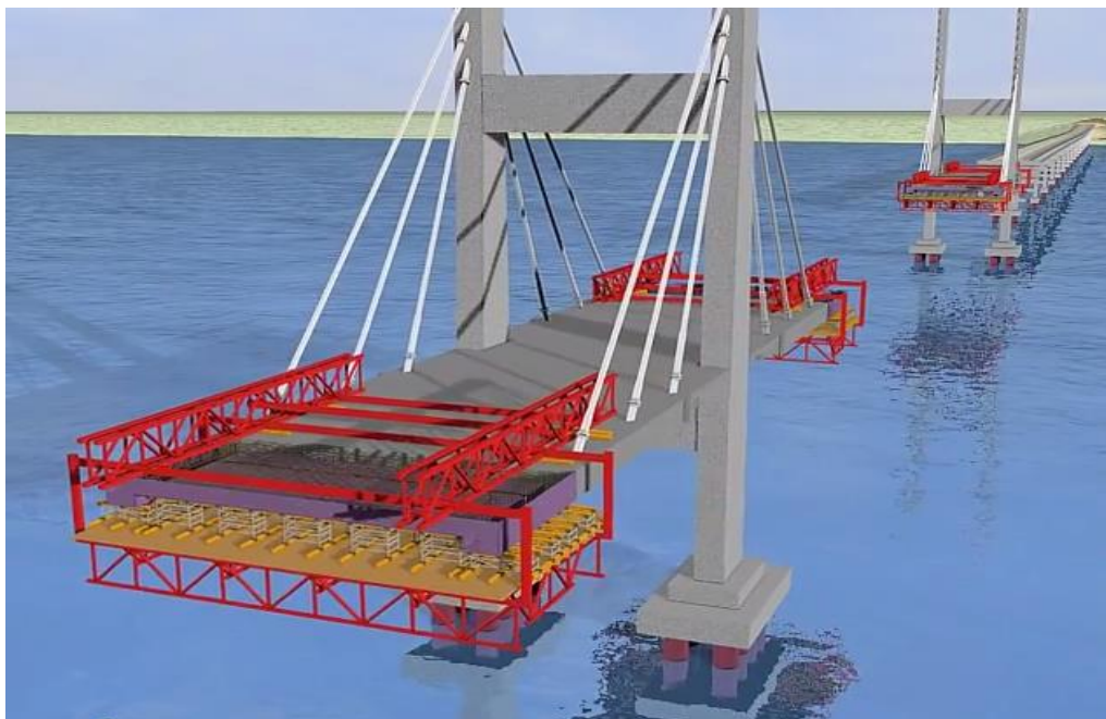
Figura 15 – Croqui da construção por treliças móveis de balanços sucessivos em ponte estaiada
