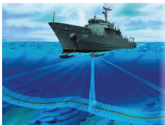
Fonte: Arquivo Fronteiras Arqueologia Exemplo de sonar usado em batimetria
