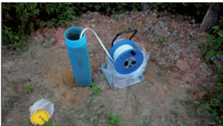
Medição do nível de água em poço perfurado com medidor elétrico
