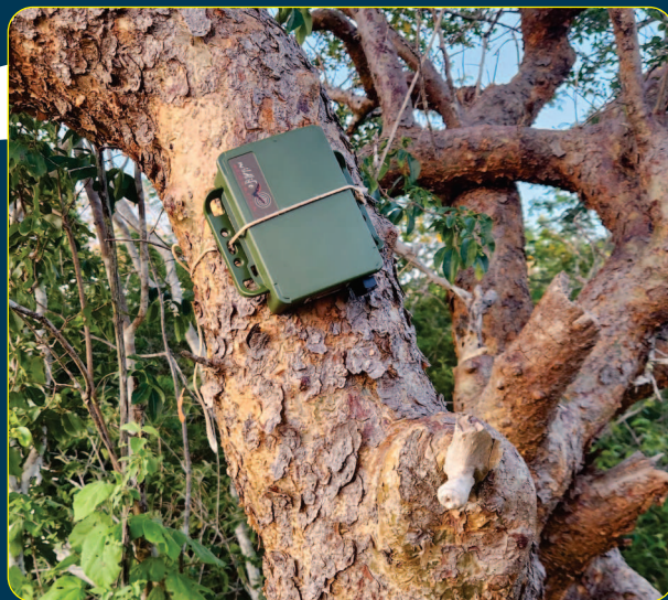
Equipamento para identificação de morcegos através dos sons emitidos.
