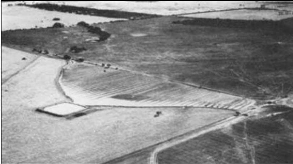
Figura 3.2.5.3 - Implúvio implantado em campo aberto para dessedentação de rebanhos.
