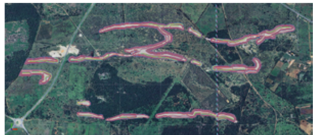
FIGURA 3.6.2 Modelo Digital de Terreno – MDT com as cavas finais (em cinza) previstas para o Alvo Juazeiro, nas poligonais dos processos ANM 870.973/2024 (em rosa tracejado) e ANM 870.974/2024 (em azul claro tracejado), nas suas configurações finais. Em azul escuro a crista do talude e em vermelho o pé do talude.
