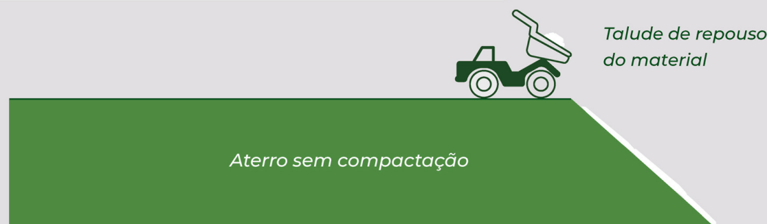
FIGURA 3.4.2.2 Esquema construtivo de pilha de estéril pelo método descendente. Fonte: Aragão, 2008.
