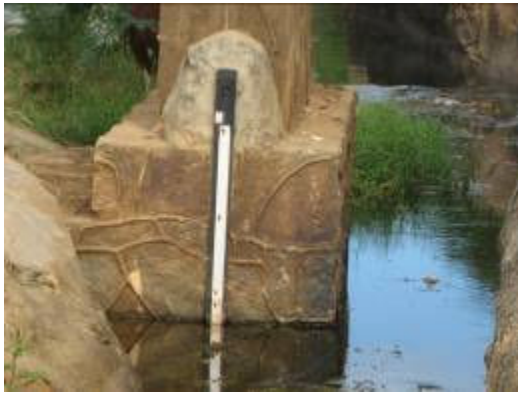
Figura 8.2.40: Régua fluviométrica da ANA na margem esquerda do rio, à montante do ponto do ponto CON-GAV-500 – Rio Gavião
