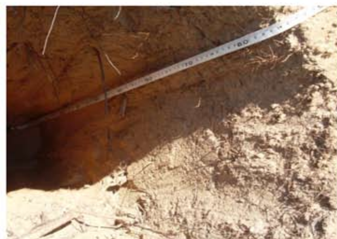
Foto 18 - trincheiras para análise de solo (20, 40, 65 e 85 cm), (20/10/2009). Fonte: Eng. Ftal Izabel C.C. de Paula, 2009.
