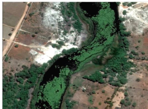
Figura 10.9 – Presença de Macrófitas no espelho d'água – indícios de eutrofização
