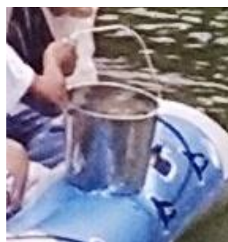
Figura 63: Balde de aço inox AISI 316 L.
