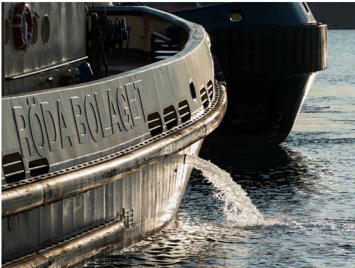
Figura 37 - Descarga de água de lastro, o vetor mais frequente de introdução de invertebrados marinhos em termos globais. Fonte: Wikimedia Commons.
