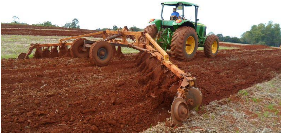
Figura 37 – Exemplo de terraceador sendo utilizado para implantação e terraços no município de Planalto/PR.
