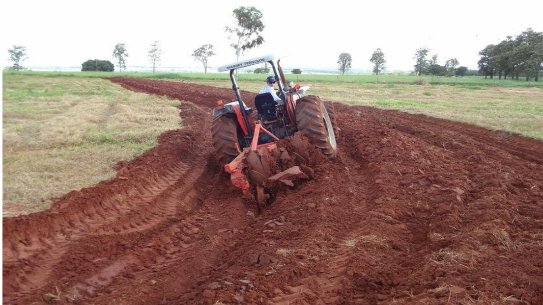
Figura 36 – Exemplo de arado de disco reversível sendo utilizado para implantação de terraços no município de Paranavaí/PR.
