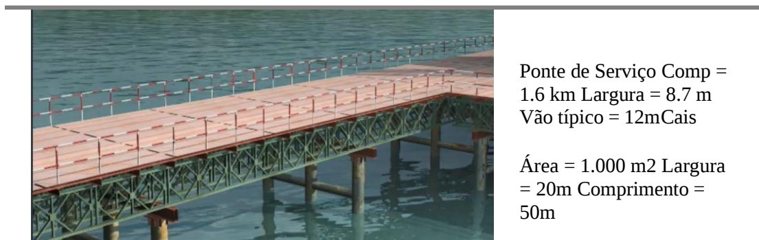
Figura 20 – Ponte de Serviço no Lado Itaparica
