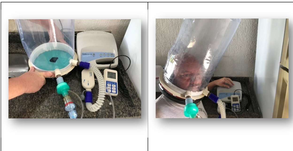
Figura 3: Capacete para CPAP, Modelo conceitual e teste funcional do protótipo
