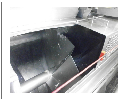
Figura 2: Máquina de escaldar patas de frango (parafuso transportador sem fim) aberta e desprovida de sistema de proteção contra acidentes
