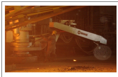
Figura 5: Equipamento (robô) de amostragem e medição de temperatura
