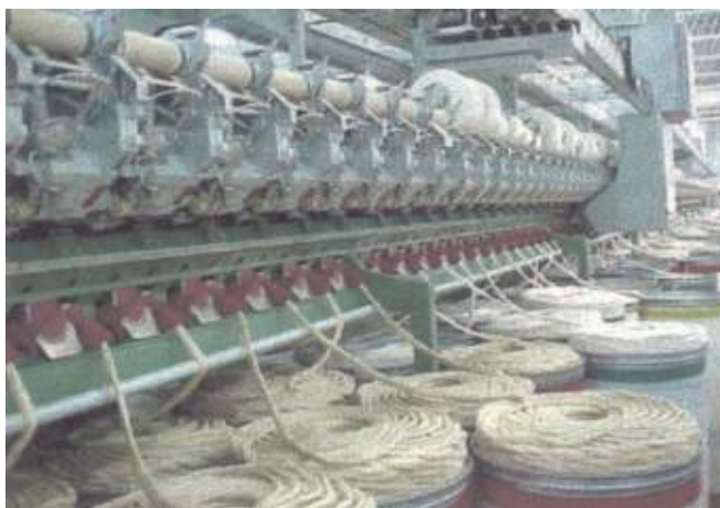
Figura 1 Filatório do tipo Open End, que representa um grande avanço na tecnologia de fiar
