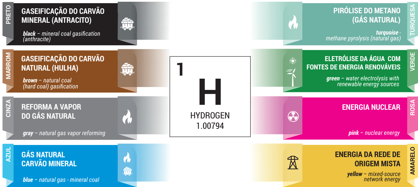
FIGURA 2.6 Definição terminológica do H_2 utilizando espectro de cores. FIGURE 2.6 Terminology definition of H_2 using color spectrum.
