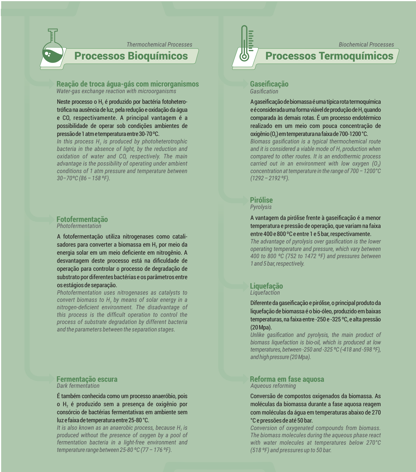
FIGURA 2.9 Tecnologias de produção de hidrogênio a partir da biomassa. FIGURE 2.9 Hydrogen production technologies from biomass.
