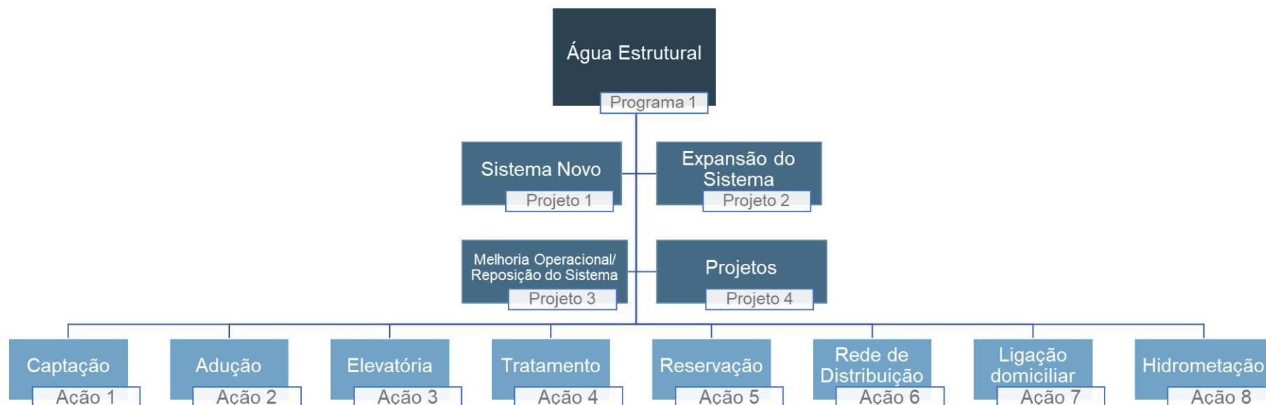
Figura 18 –Programas, projetos e ações do Sistema de Abastecimento de Água
