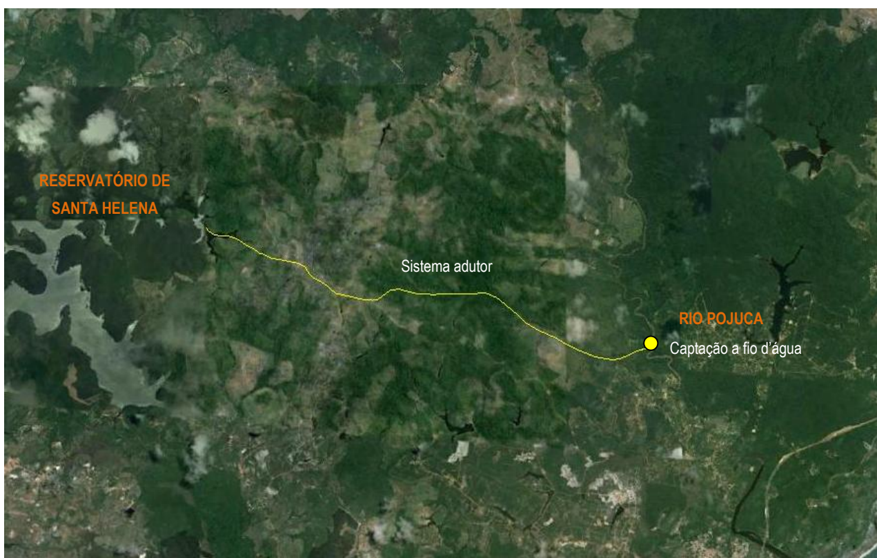
Figura 6.13 - Localização do ponto de captação a fio d'água no rio Pojuca e o esquema do sistema adutor Pojuca-Santa Helena
