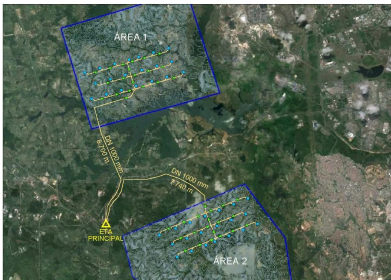
Figura 8.2 - Captação de água subterrânea e adução para a ETA Principal
