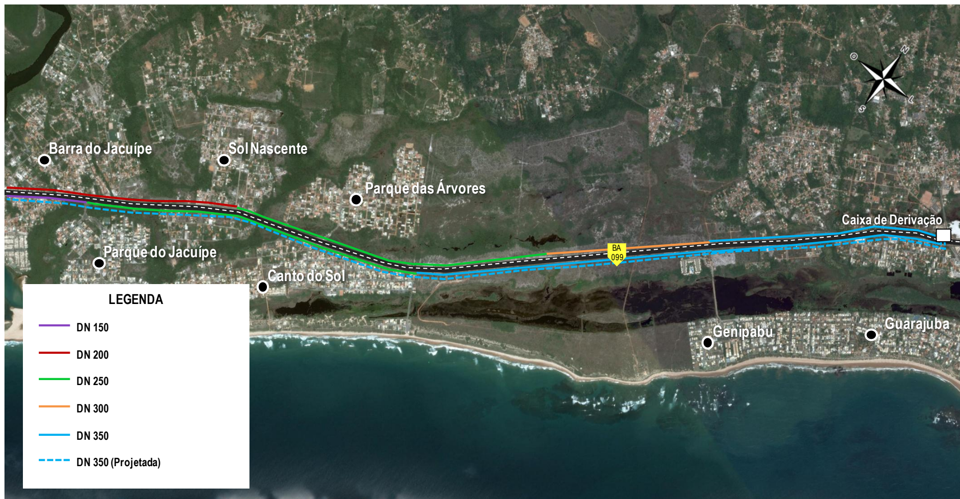
Figura 2.11 – Croqui Esquemático do Novo Sistema de Linhas Tronco do SIAA Jordão (Parte 2/3)
