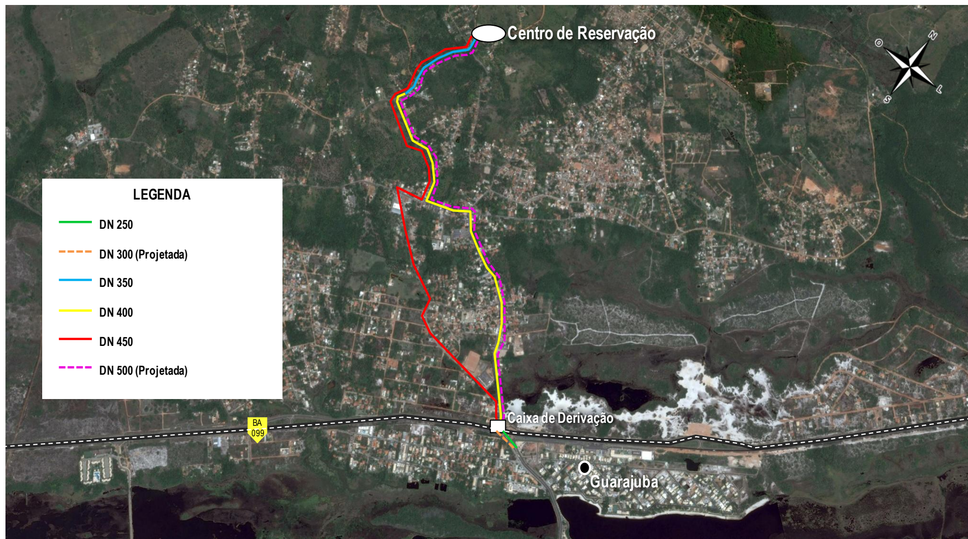
Figura 2.10 – Croqui Esquemático do Novo Sistema de Linhas Tronco do SIAA Jordão (Parte 1/3)
