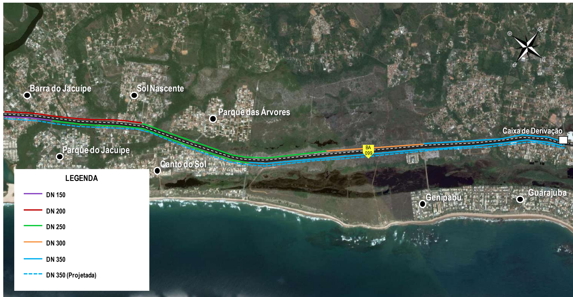
Figura 3. 14 – Croqui Esquemático do Novo Sistema de Linhas Tronco do SIAA Jordão (Parte 2/3)
