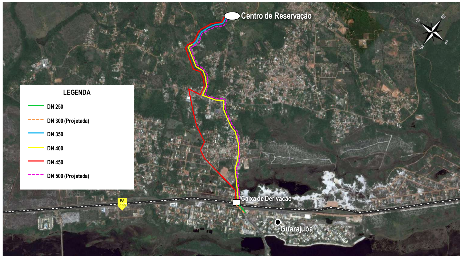
Figura 3. 13 – Croqui Esquemático do Novo Sistema de Linhas Tronco do SIAA Jordão (Parte 1/3)
