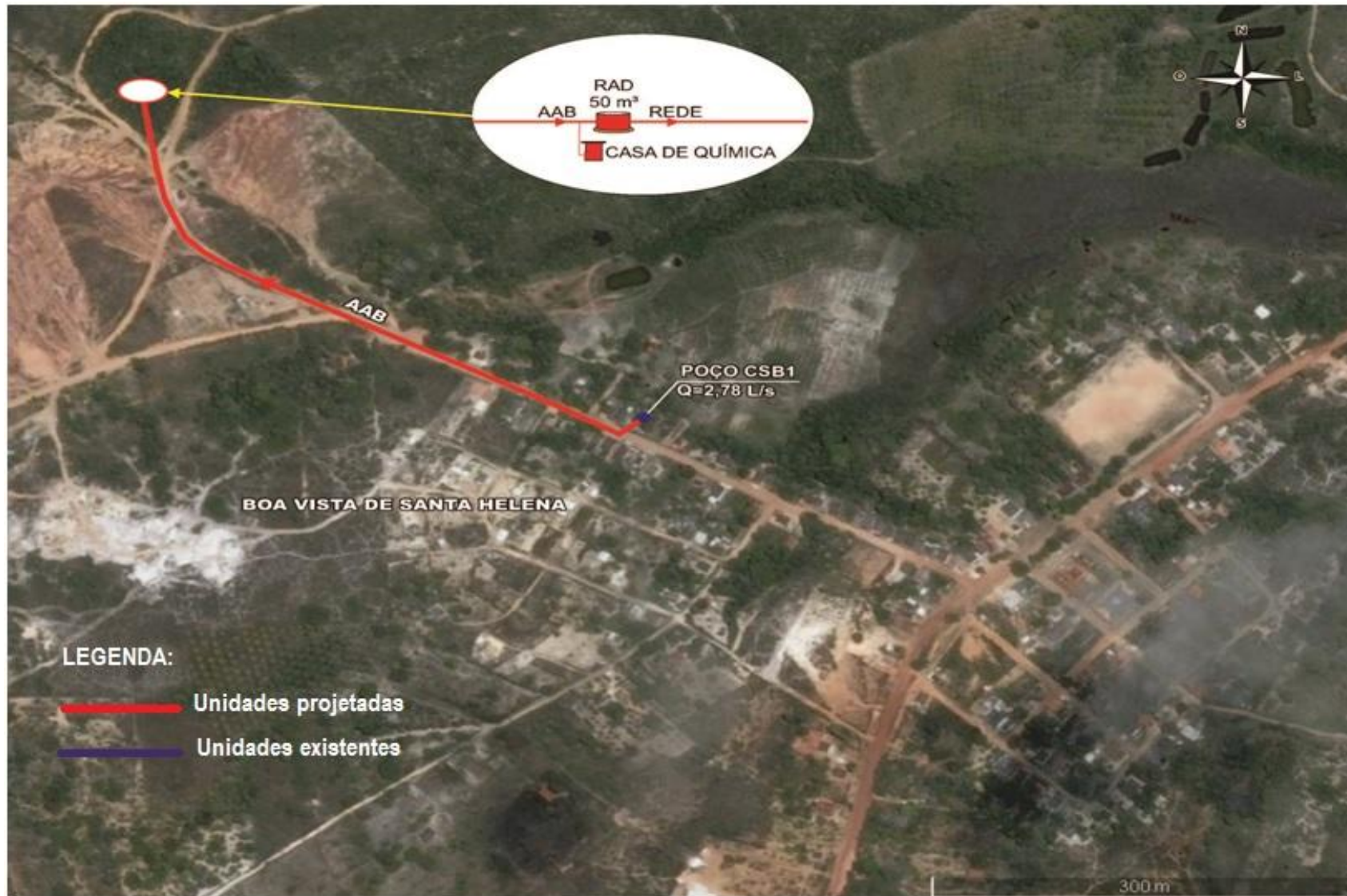
Figura 2.11 – Concepção Proposta para o SAA de Boa Vista de Santa Helena Fonte: GEOHIDRO, 2015
