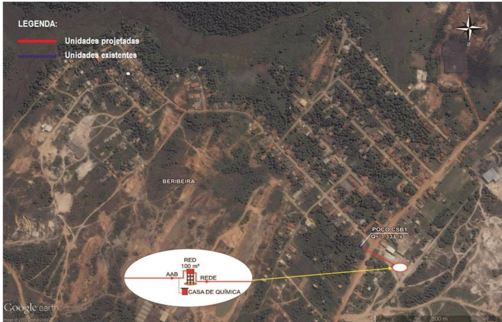
Figura 2.9 – Concepção Proposta para o SAA de Biribeira Fonte: GEOHIDRO, 2015
