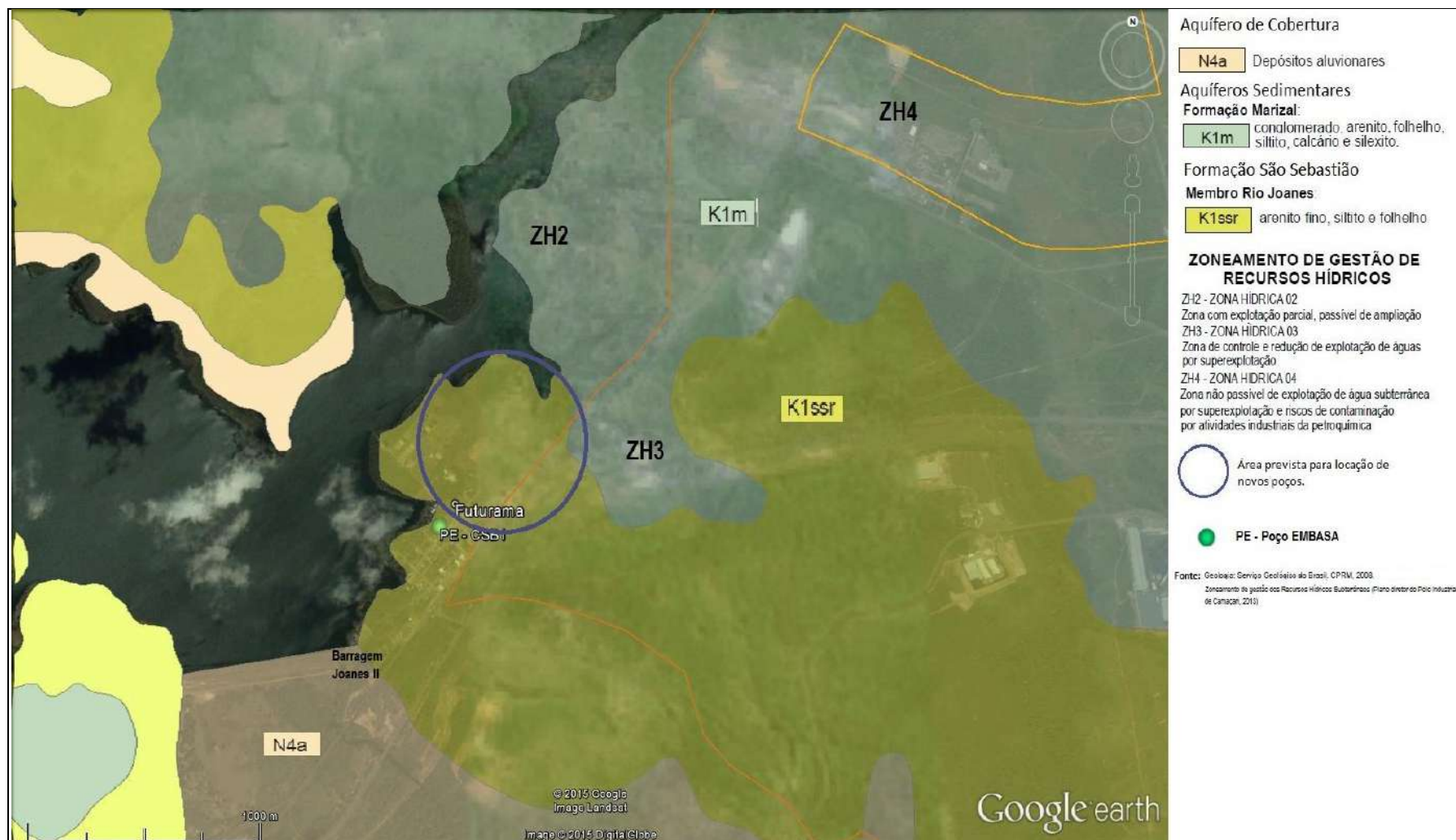
Figura 3.9 – Mapa Hidrogeológico da localidade de Futurama, poço existente e proposta de locação.
