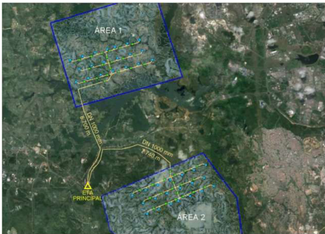
Figura 1.9 - Captação de água subterrânea e adução para a ETA Principal
