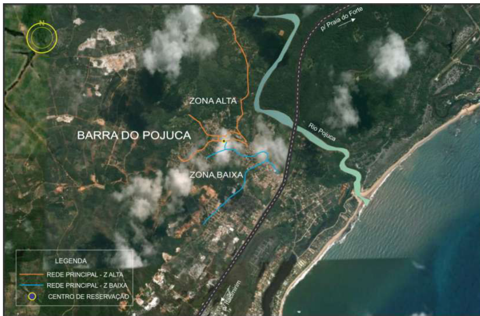
Figura 6.41 - Esquema geral da rede principal de Barra do Pojuca
