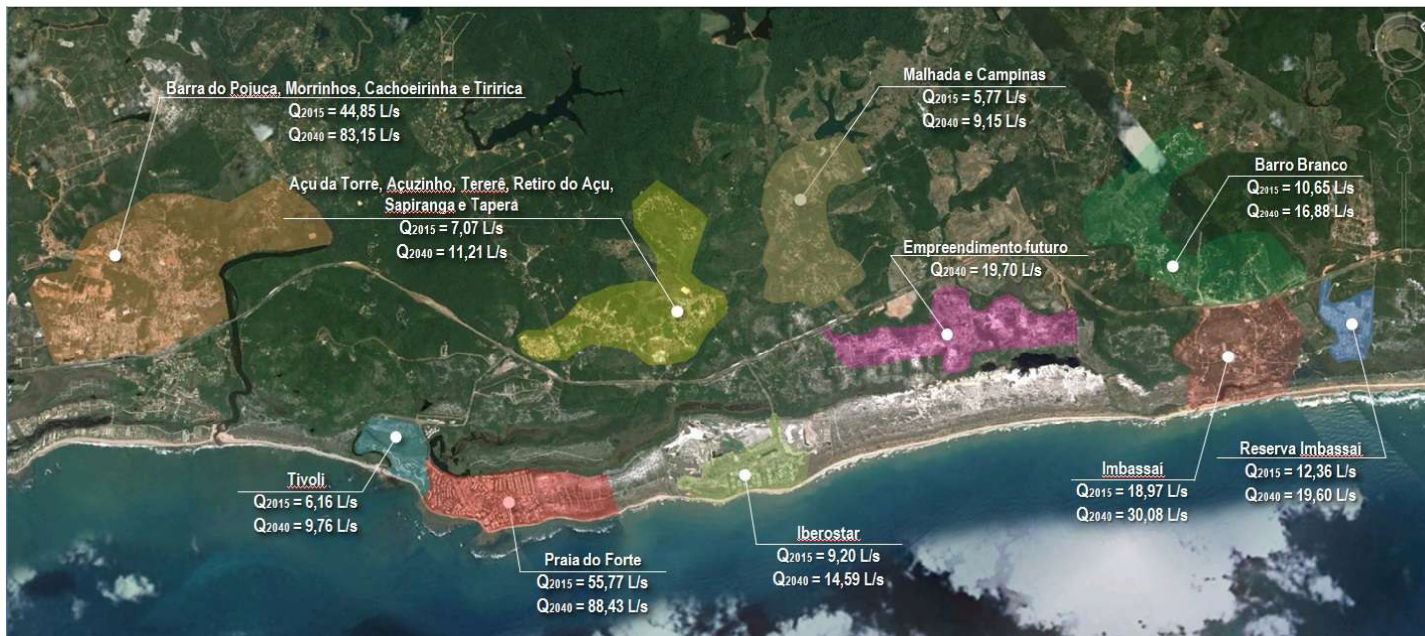
Figura 6.26 – Distribuição das localidades atendidas pelo SIAA de Barra do Pojuca e as demandas máximas diárias em final de plano
