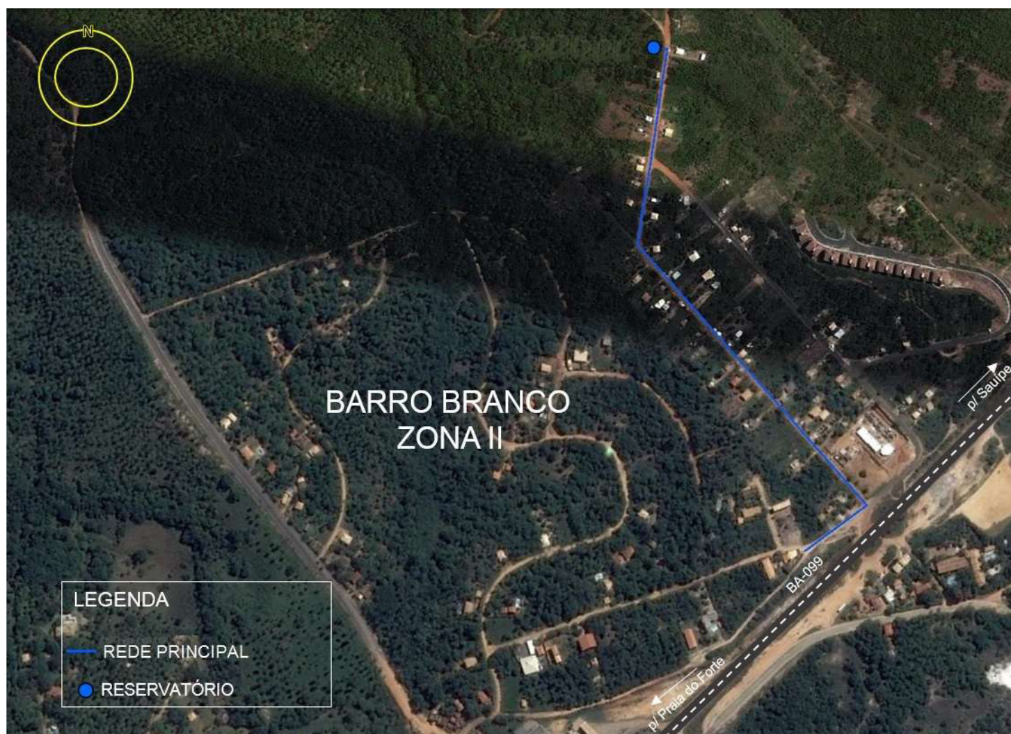
Figura 6.46 - Esquema geral da rede principal de Barro Branco – Zona 2
