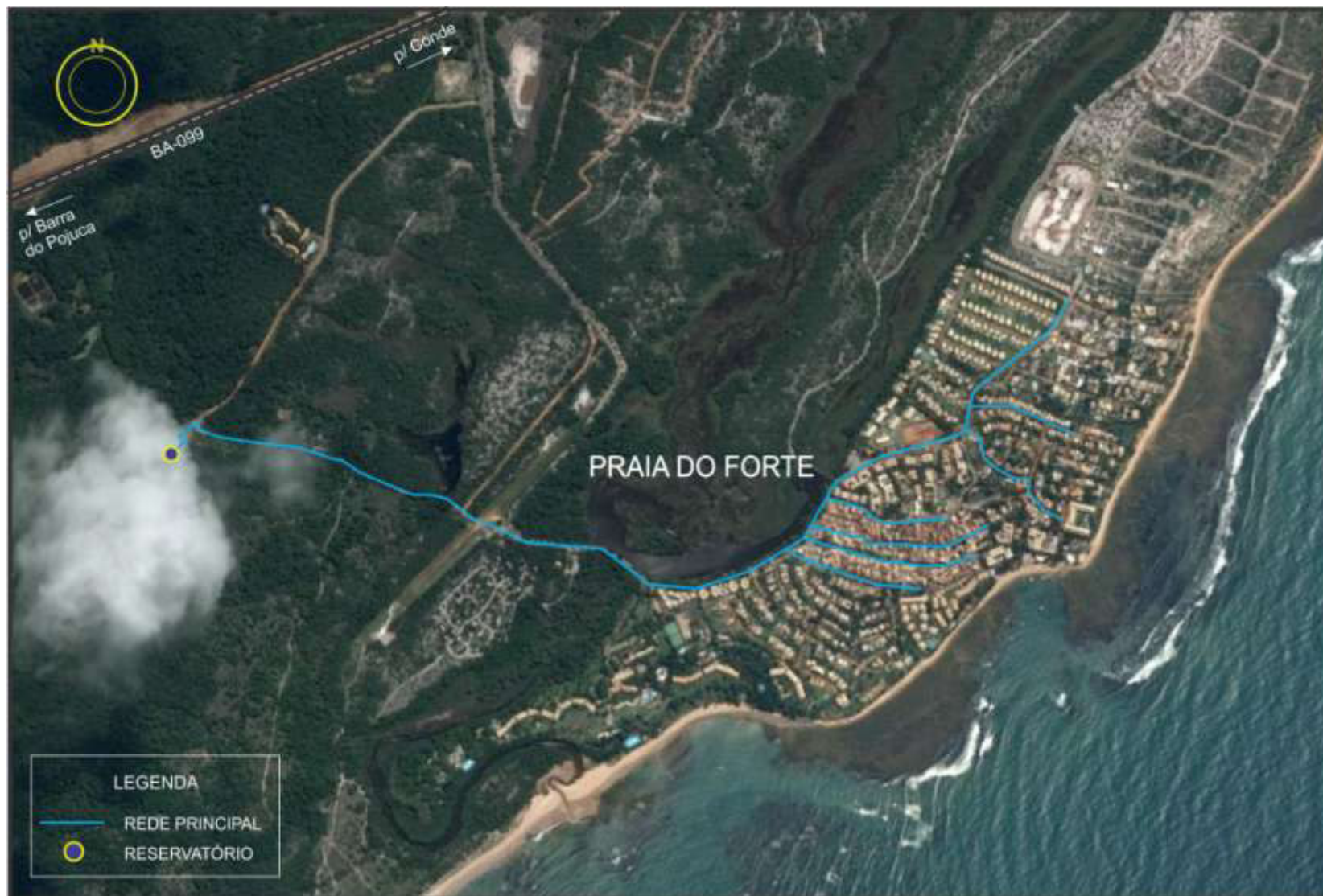
Figura 6.42 - Esquema geral da rede principal de Praia do Forte
