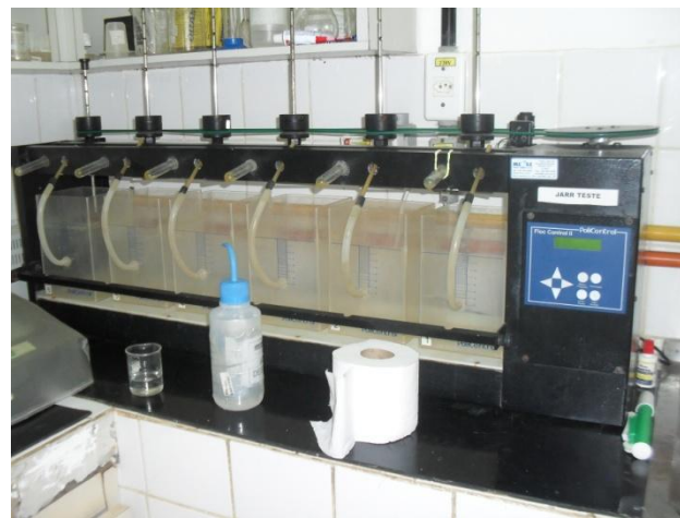
Figura 5.39 - Equipamento de Jar-Test
