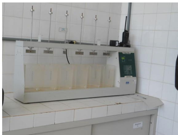
Figura 5.106 – Aparelho de “Jar-test” utilizado no ensaio para determinação de concentração de coagulante.
