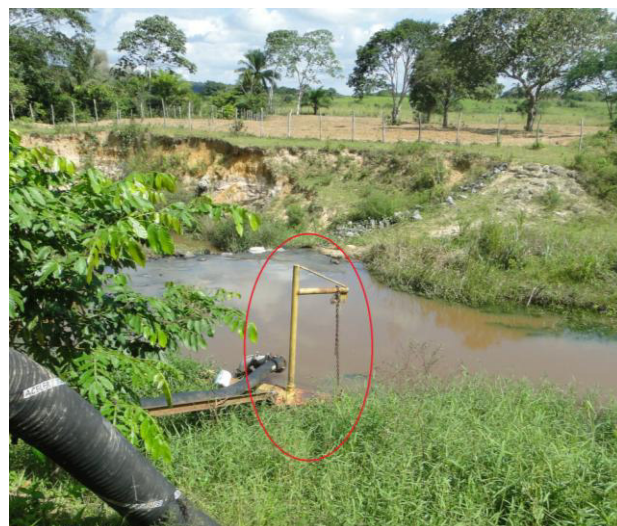
Figura 5.42 –Dispositivo de içamento para a bomba submersa
