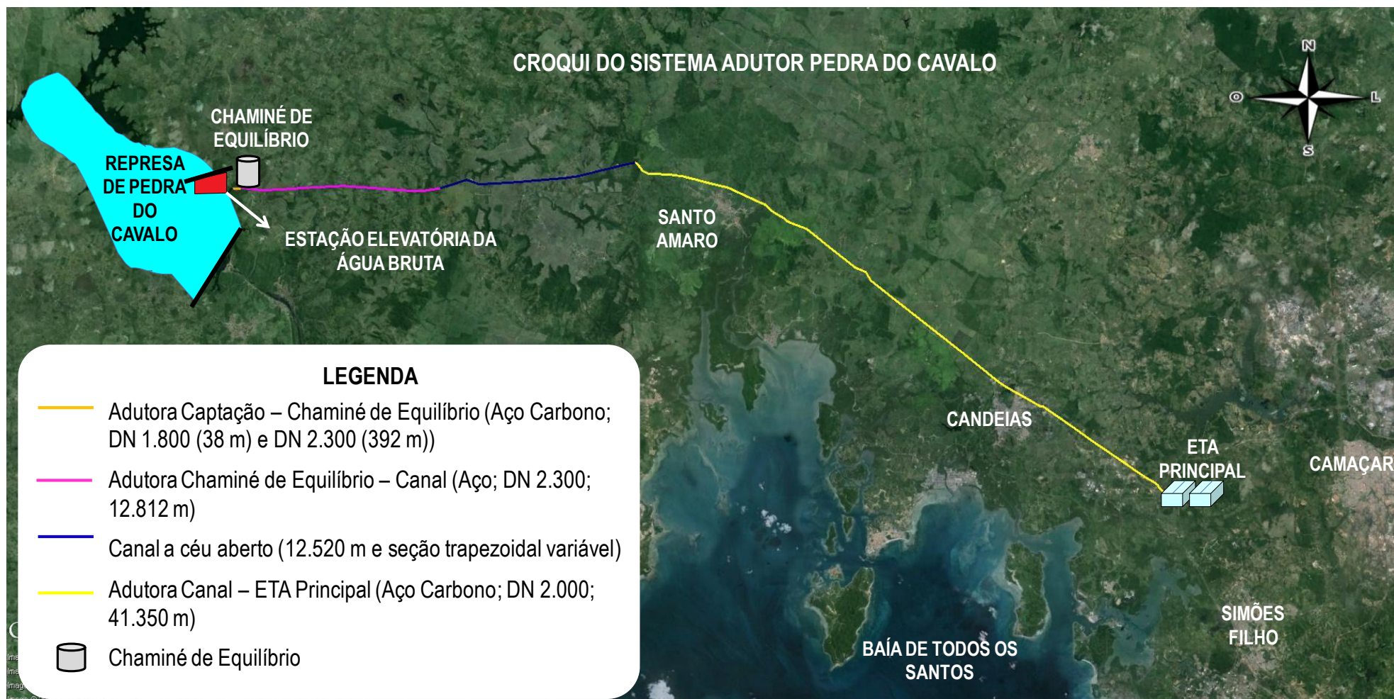
Figura 1.1 – Croqui do Sistema Adutor Pedro do Cavallo
