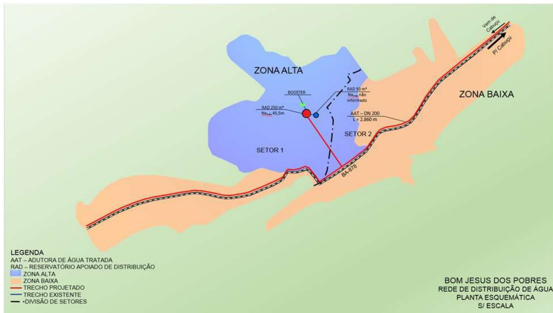
Figura 3.33 - Planta esquemática das unidades principais e zonas de pressão - Bom Jesus dos Pobres
