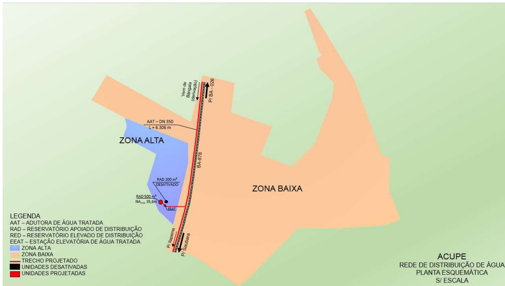
Figura 3.14 - Planta esquemática das unidades principais e das zonas de pressão - Acupe
