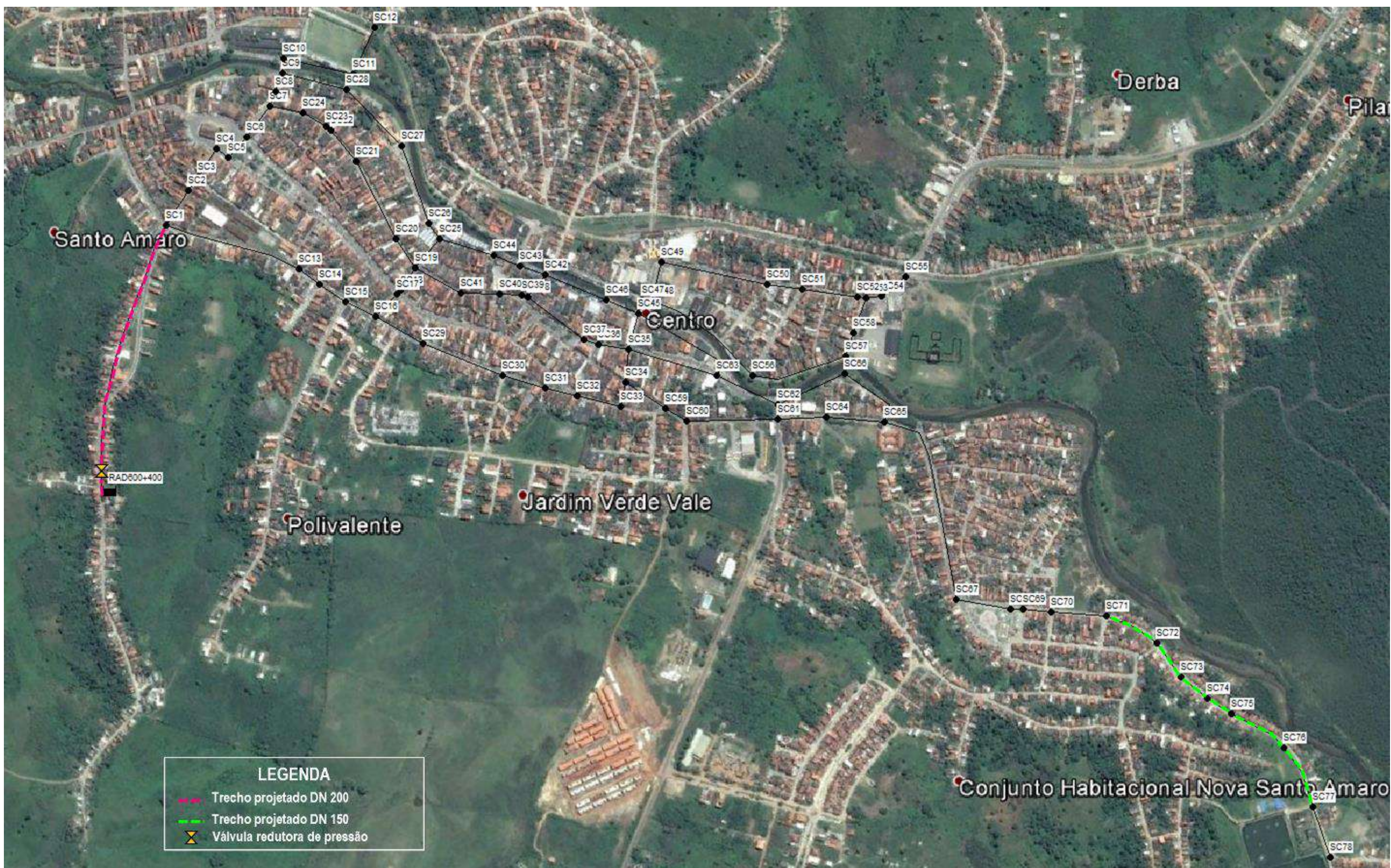
Figura 3. 6 - Avaliação da rede após as intervenções propostas - SAA de Santo Amaro (Setor C)
