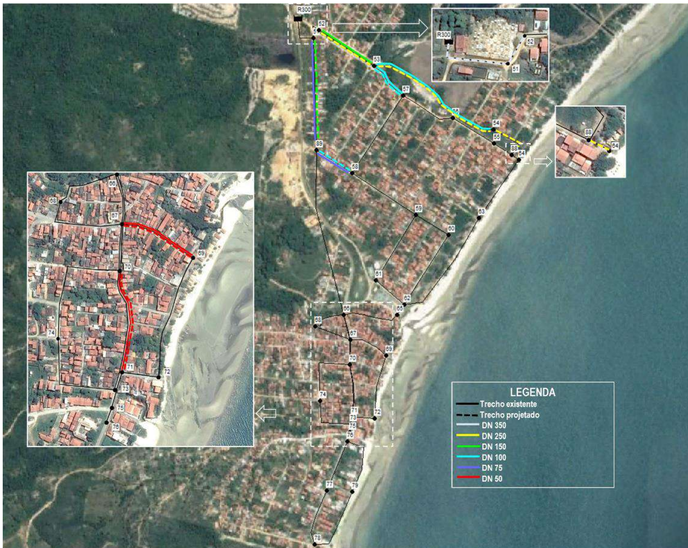
Figura 3. 19 - Avaliação da rede existente - Cabuçu (Zona Baixa 1)
