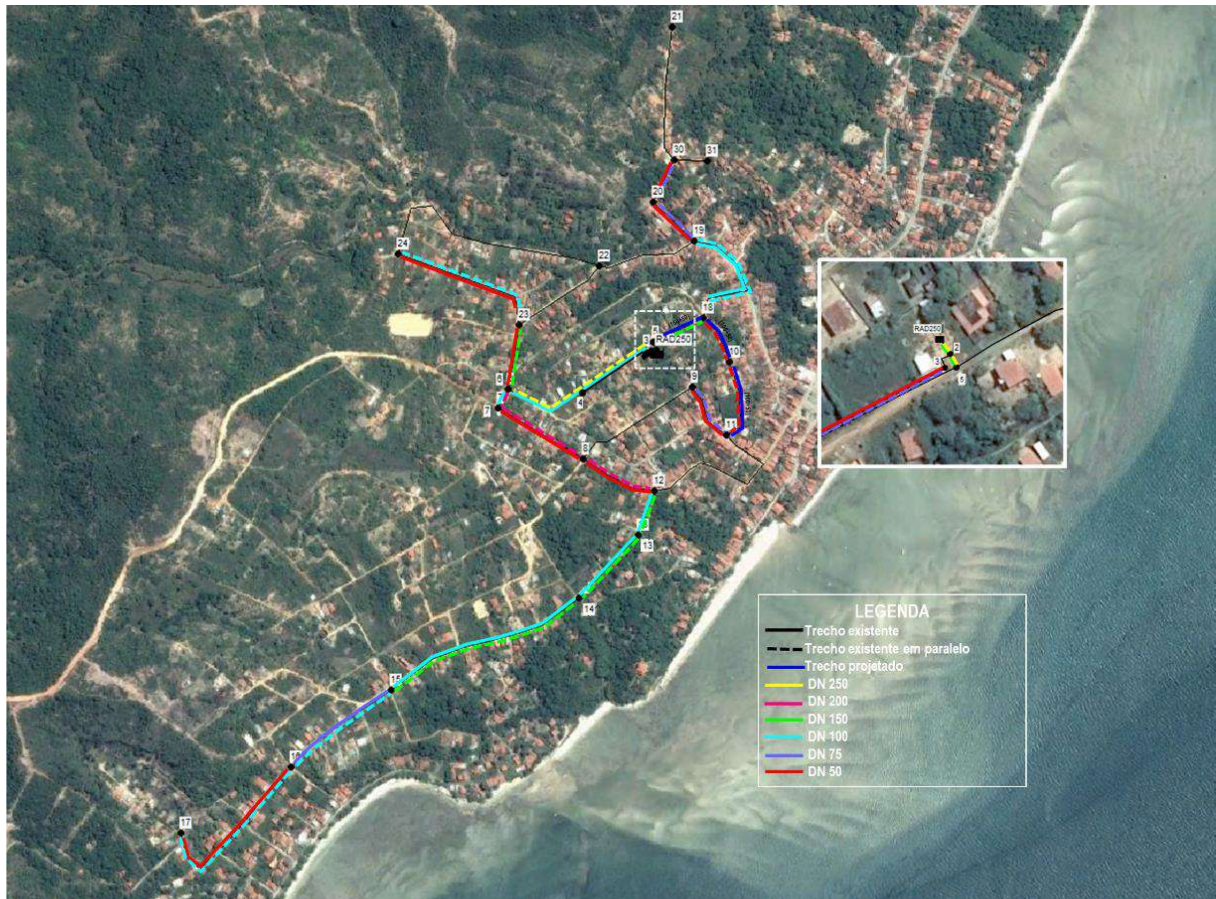
Figura 3. 21 - Avaliação da rede existente - Bom Jesus dos Pobres (Setor 1)
