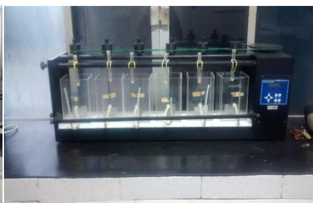
Figura 2.22 - Bancada de jar-test
