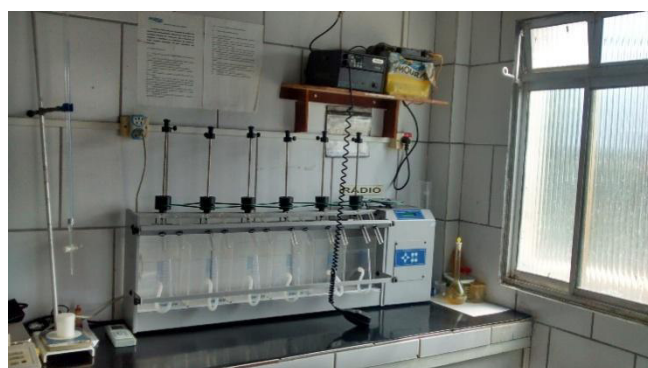
Figura 2.140 - Bancada de Jar-test
