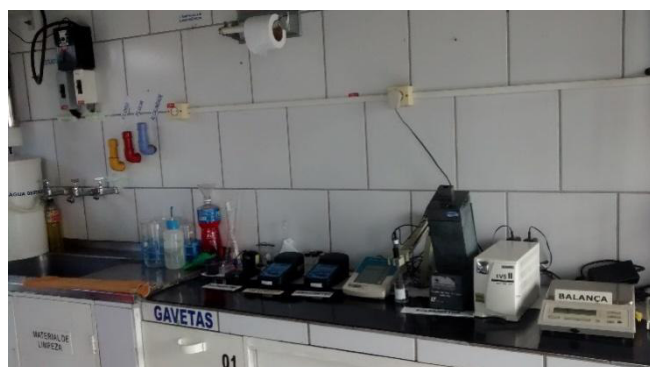
Figura 2.139 - Equipamentos utilizados para análise de: cloro residual, flúor, turbidez, pH, e cor
