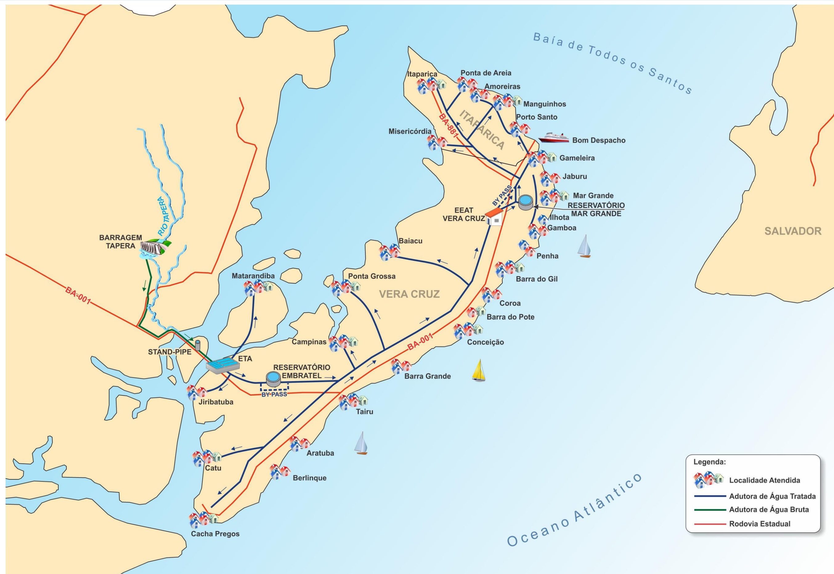
Figura 7.1 – Esquema geral simplificado do SIAA Ilha de Itaparica
