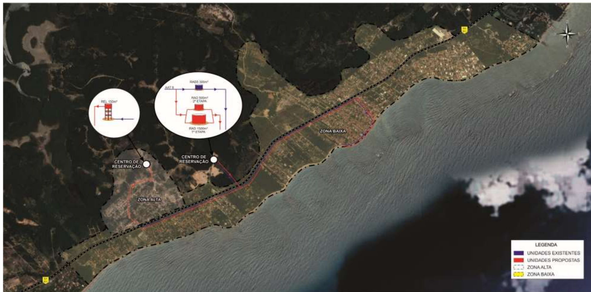
Figura 3.15 – Esquema Geral Proposto da Rede de Abastecimento de Barra Grande – Com Ponte
