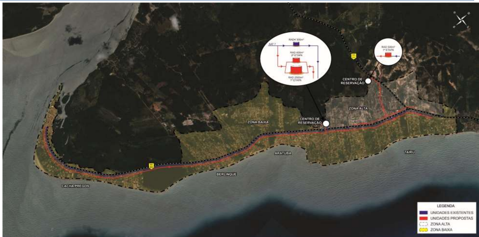
Figura 2.15 – Esquema Geral Proposto da Rede de Abastecimento de Aratuba, Berlinque, Tairú e Cacha Pregos – Sem Ponte
