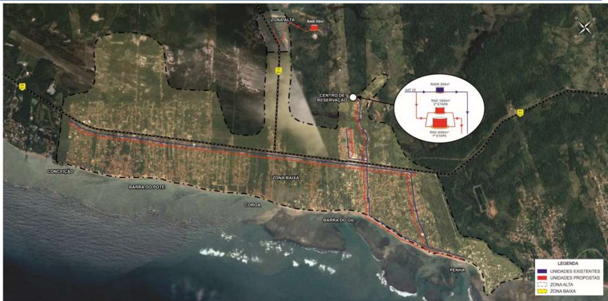
Figura 3.18 – Esquema Geral Proposto da Rede de Abastecimento de Barra do Gil, Barra do Pote, Conceição, Coroa e Penha – Com Ponte
