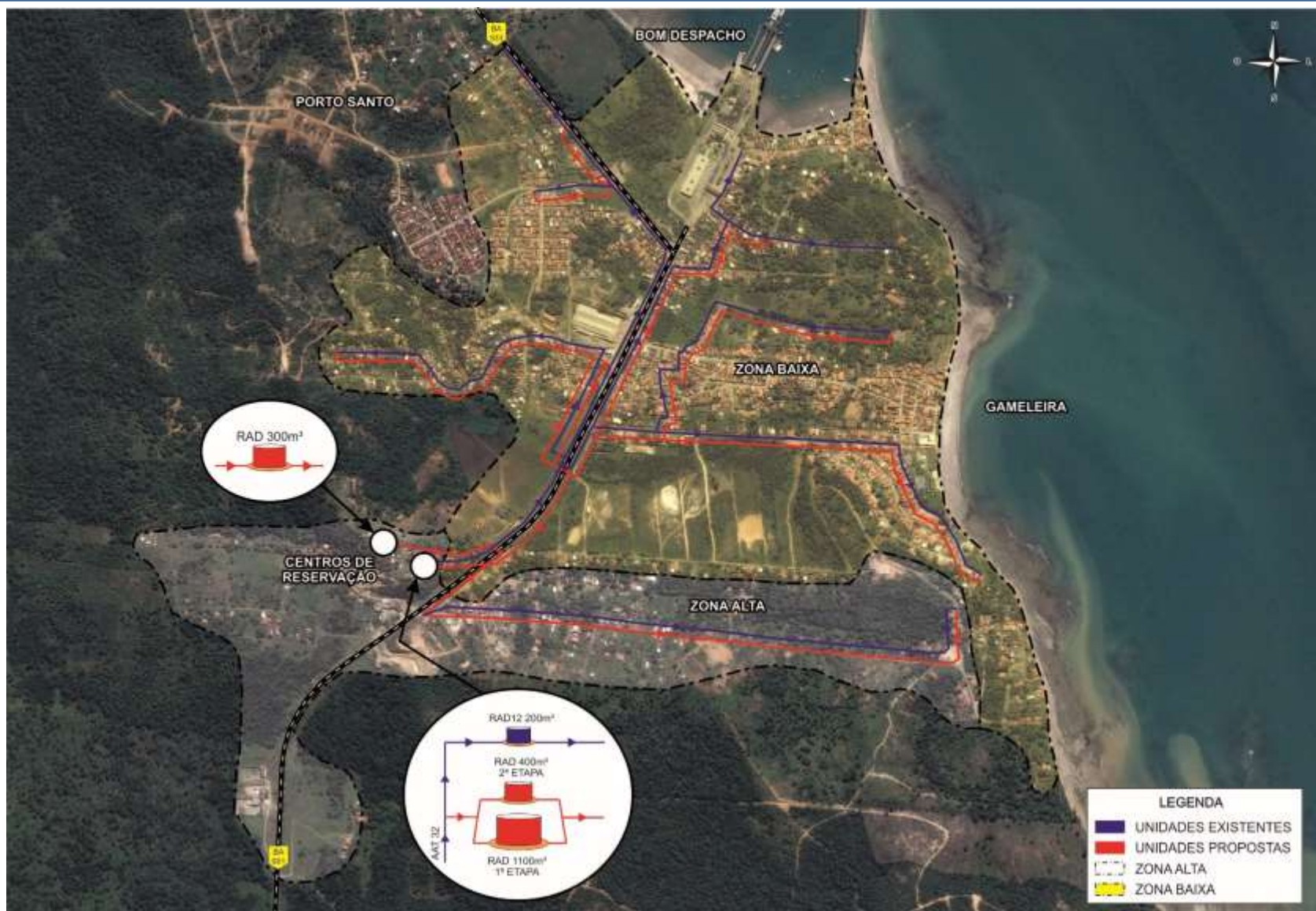
Figura 3.22 – Esquema Geral Proposto da Rede de Gameleira e Bom Despacho – Com Ponte
