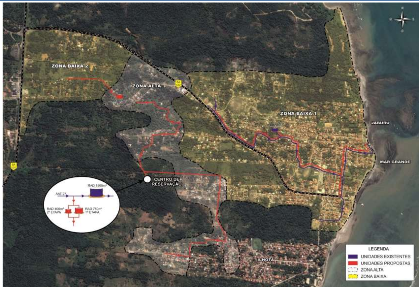
Figura 2.22 – Esquema Geral Proposto da Rede de Mar Grande e Jaburu – Sem Ponte
