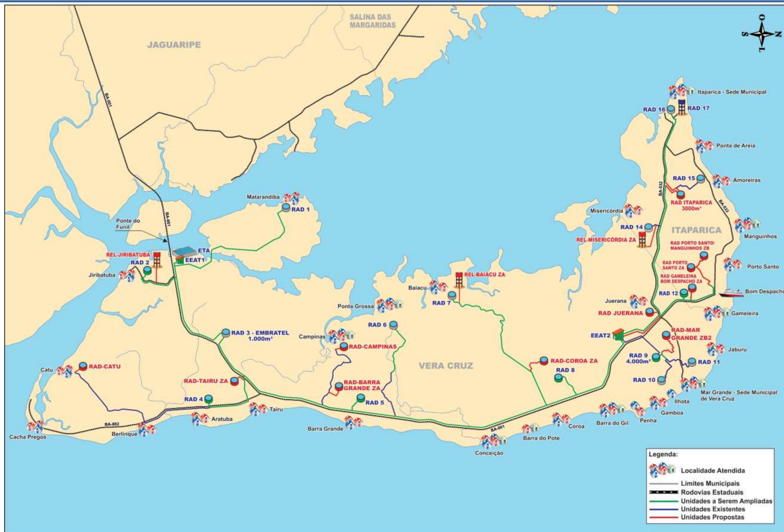
Figura 3.3 - Esquema Geral Simplificado do Sistema de Distribuição do SIAA Ilha de Itaparica – Cenário Com Ponte Elaboração: GEOHIDRO, 2015
