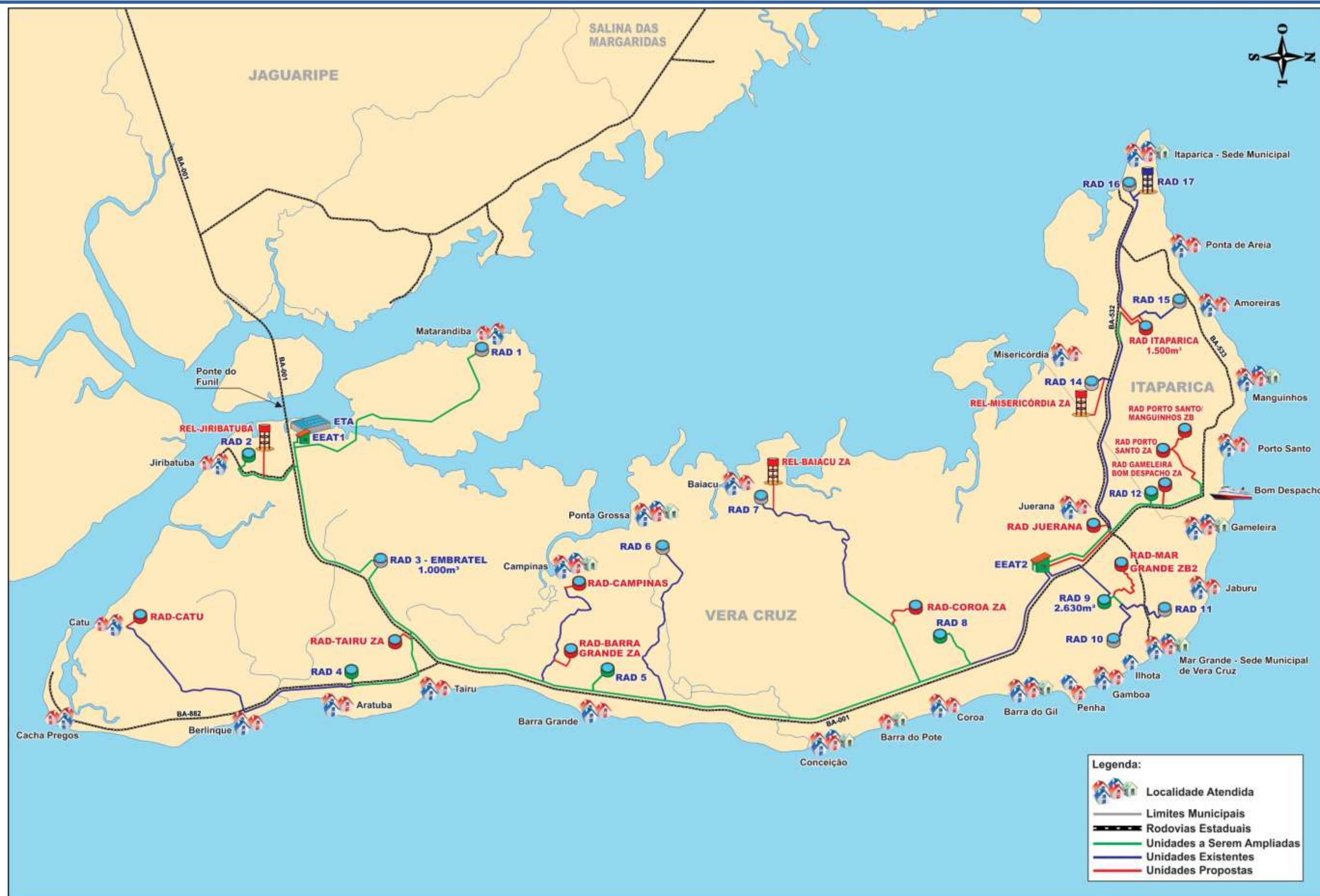
Figura 2.5 - Esquema Geral Simplificado do Sistema de Distribuição do SIAA Ilha de Itaparica – Cenário Sem Ponte Elaboração: GEOHIDRO, 2015
