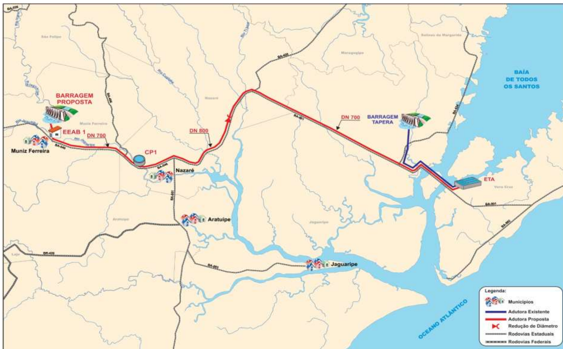
Figura 2.1 – Croqui da Concepção do Sistema Produtor Proposto para o SIAA Ilha de Itaparica Sem Ponte
