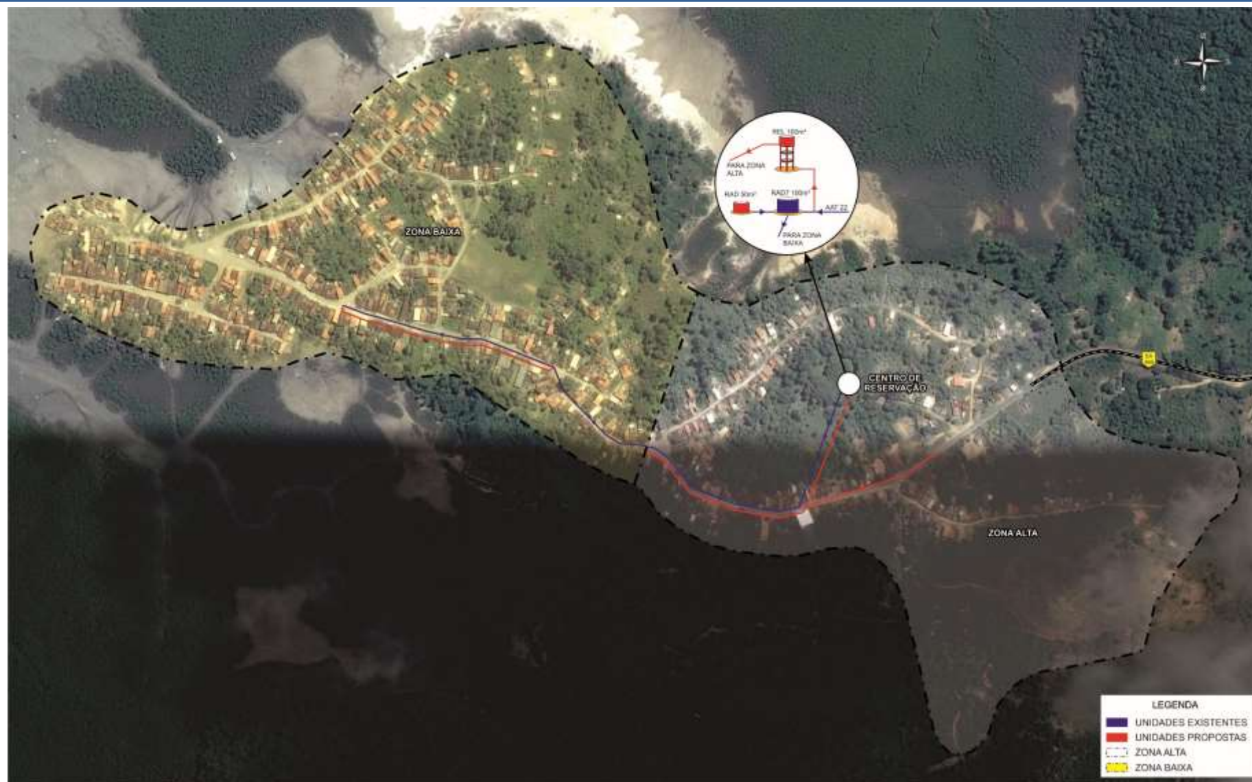
Figura 3.17 – Esquema Geral Proposto da Rede de Abastecimento de Baiacu – Com Ponte
