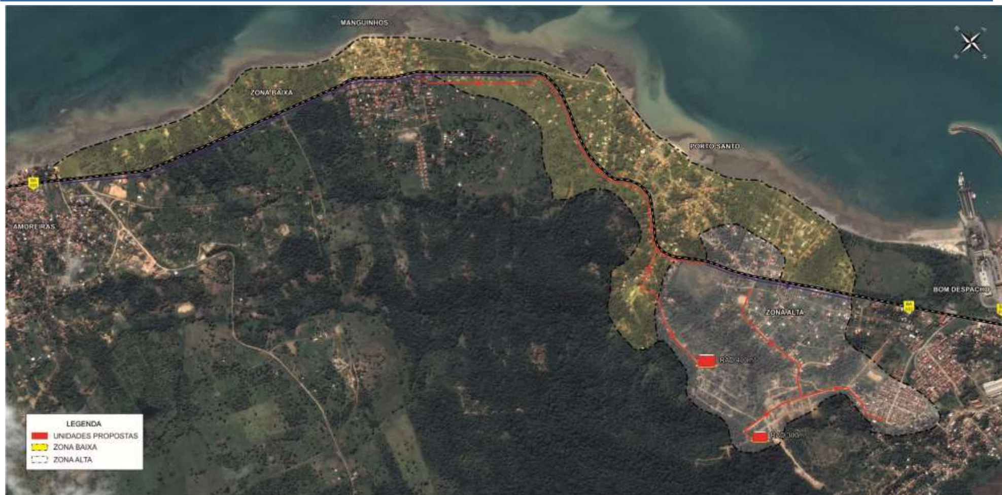
Figura 2.25 – Esquema Geral Proposto da Rede de Porto Santo e Manguinhos (ZB)– Sem Ponte
