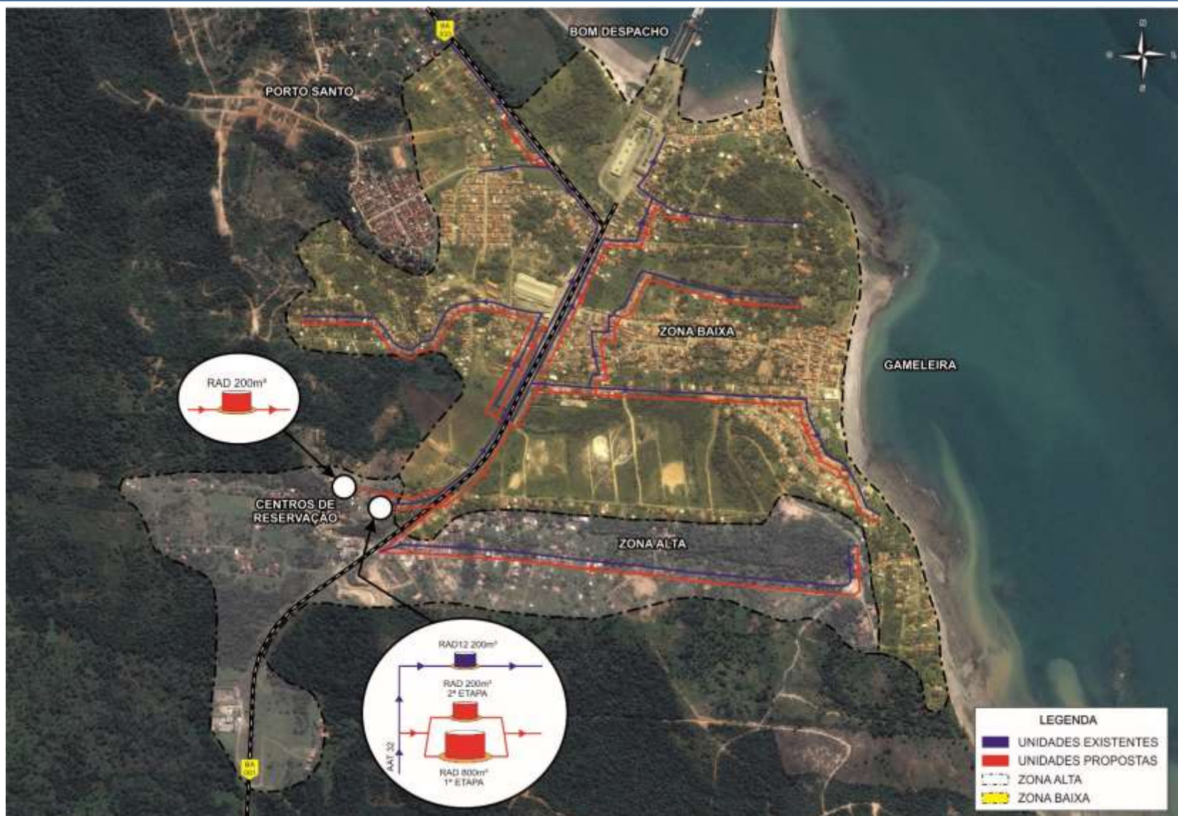
Figura 2.24 – Esquema Geral Proposto da Rede de Gameleira e Bom Despacho – Sem Ponte
