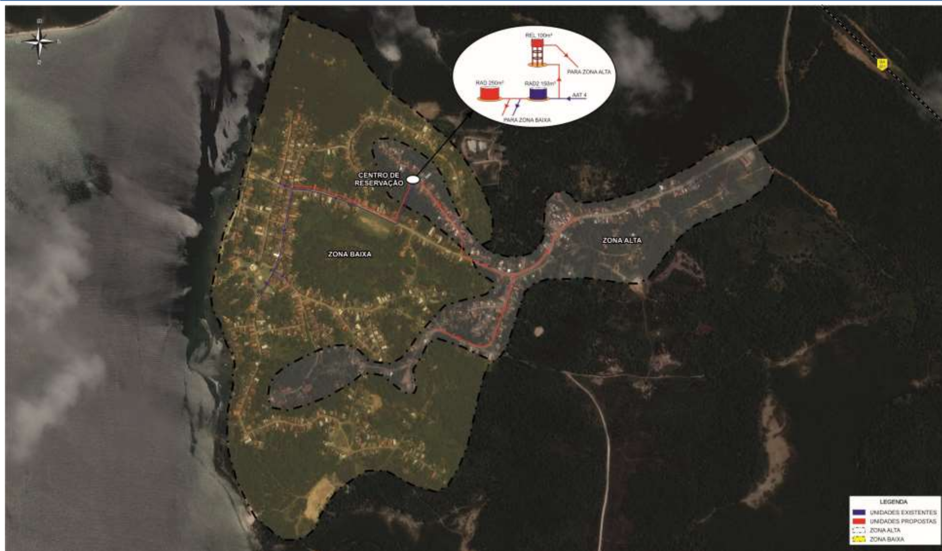
Figura 2.13 – Esquema Geral Proposto da Rede de Abastecimento de Jiribatuba – Sem Ponte
