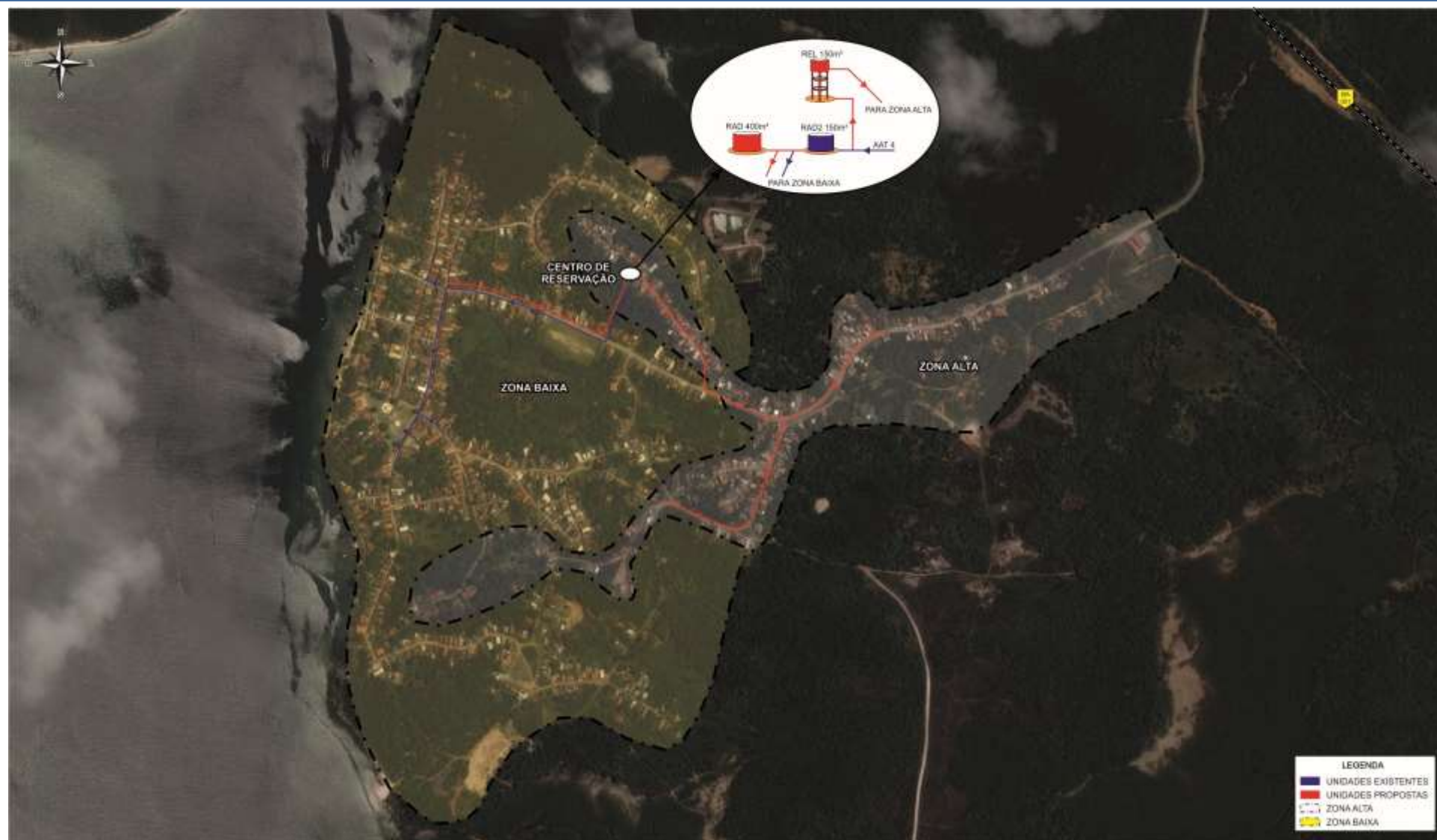
Figura 3.11 – Esquema Geral Proposto da Rede de Abastecimento de Jiribatuba – Com Ponte
