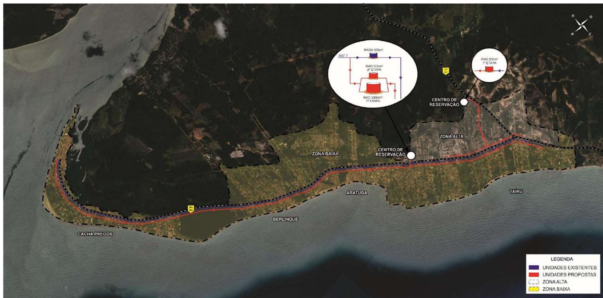
Figura 5.22 – Esquema Geral Proposto da Rede de Abastecimento de Aratuba, Berlinque, Tairú e Cacha Pregos – Alternativa A Com Ponte
