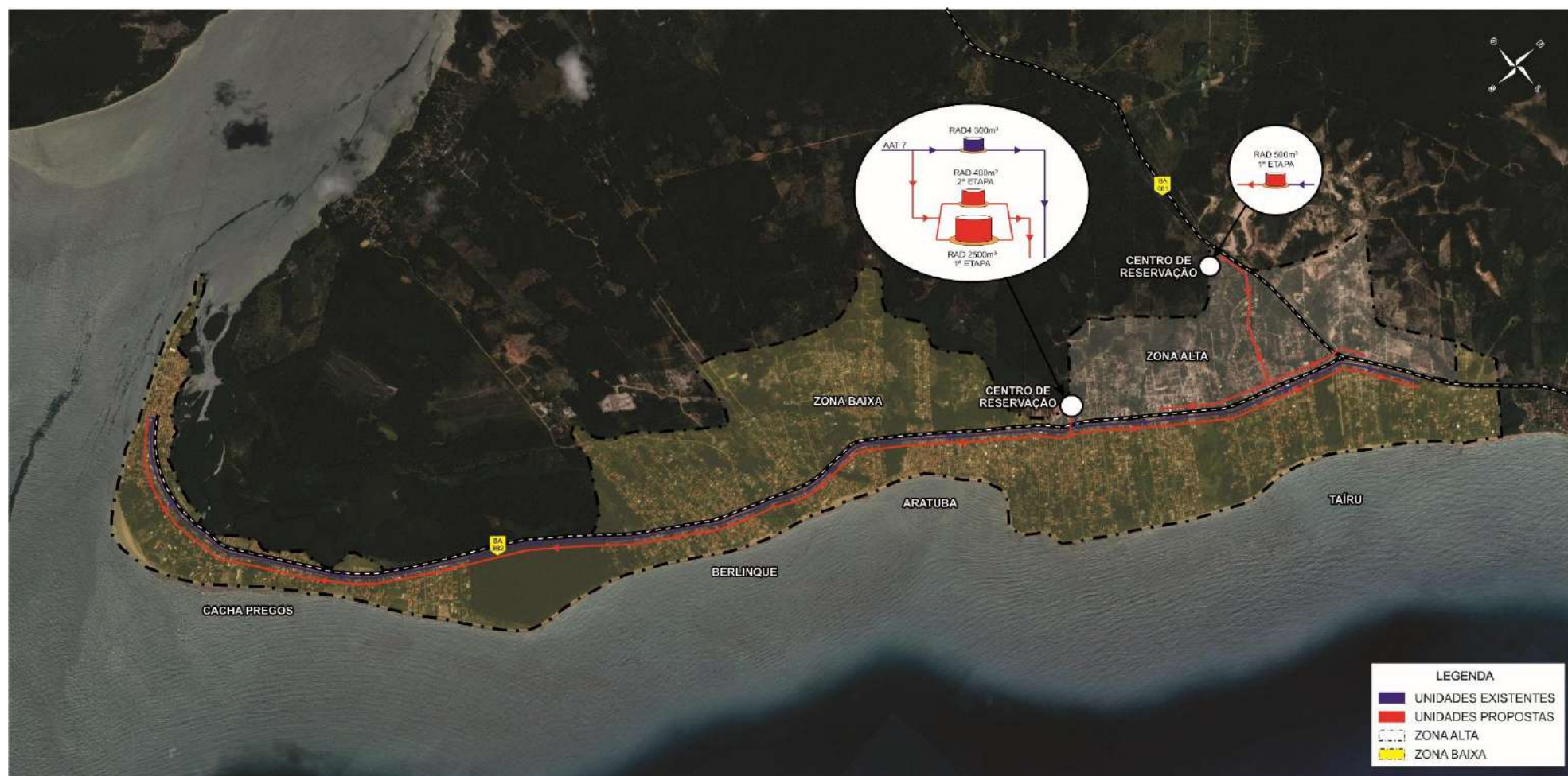
Figura 4.23 – Esquema Geral Proposto da Rede de Abastecimento de Aratuba, Berlinque, Tairú e Cacha Pregos – Alternativa A Sem Ponte
