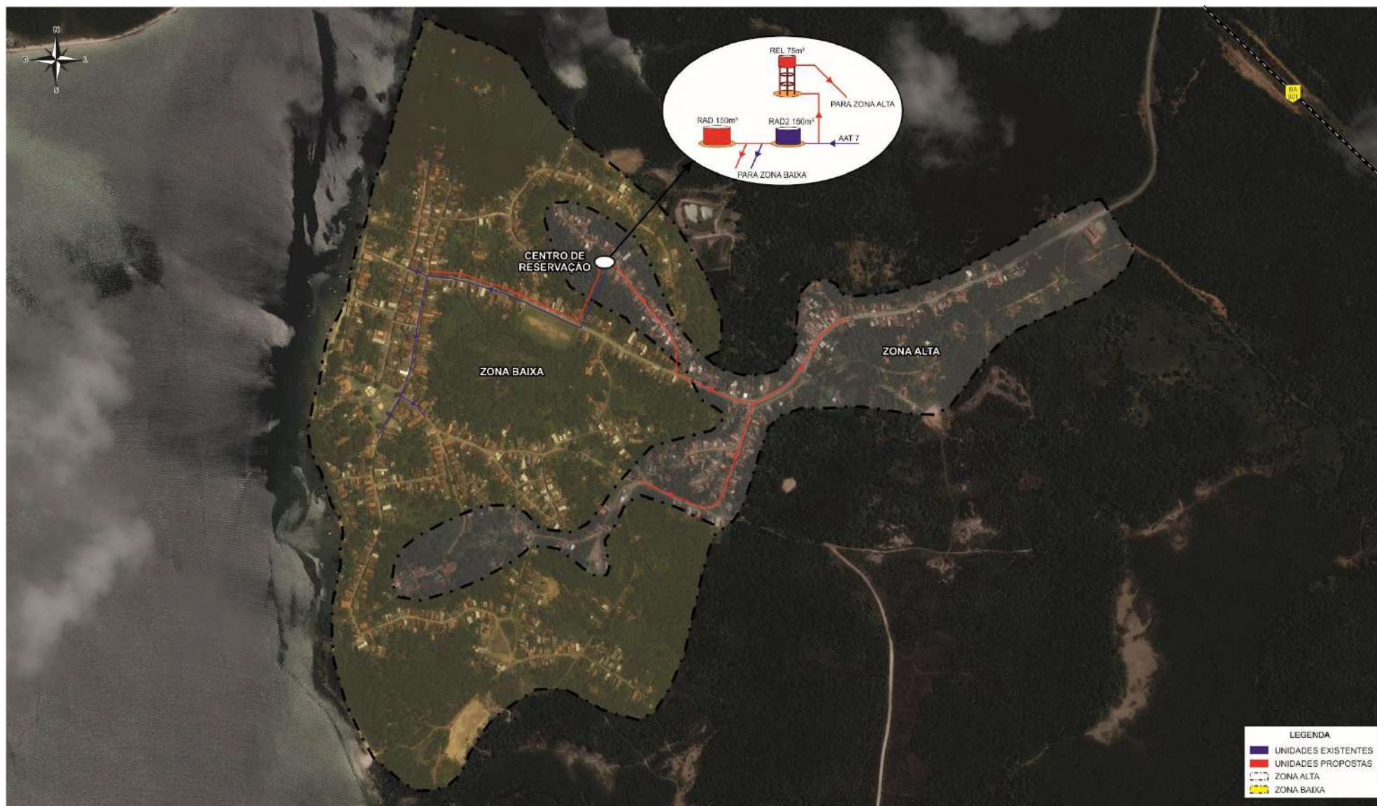
Figura 5.45 – Esquema Geral Proposto da Rede de Abastecimento de Jiribatuba – Alternativa B Com Ponte
