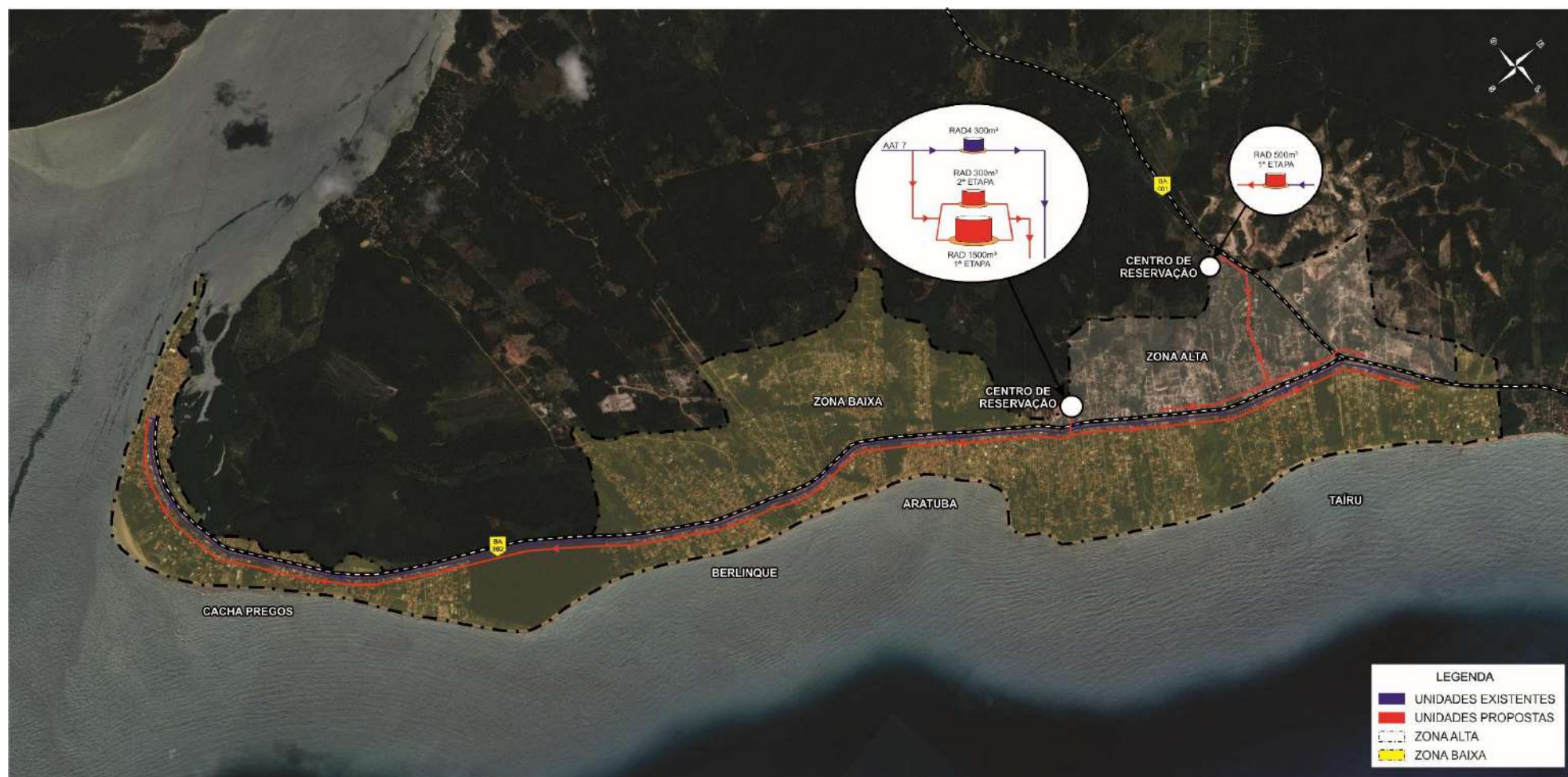
Figura 5.47 – Esquema Geral Proposto da Rede de Abastecimento de Aratuba, Berlinque, Tairú e Cacha Pregos – Alternativa B Com Ponte
