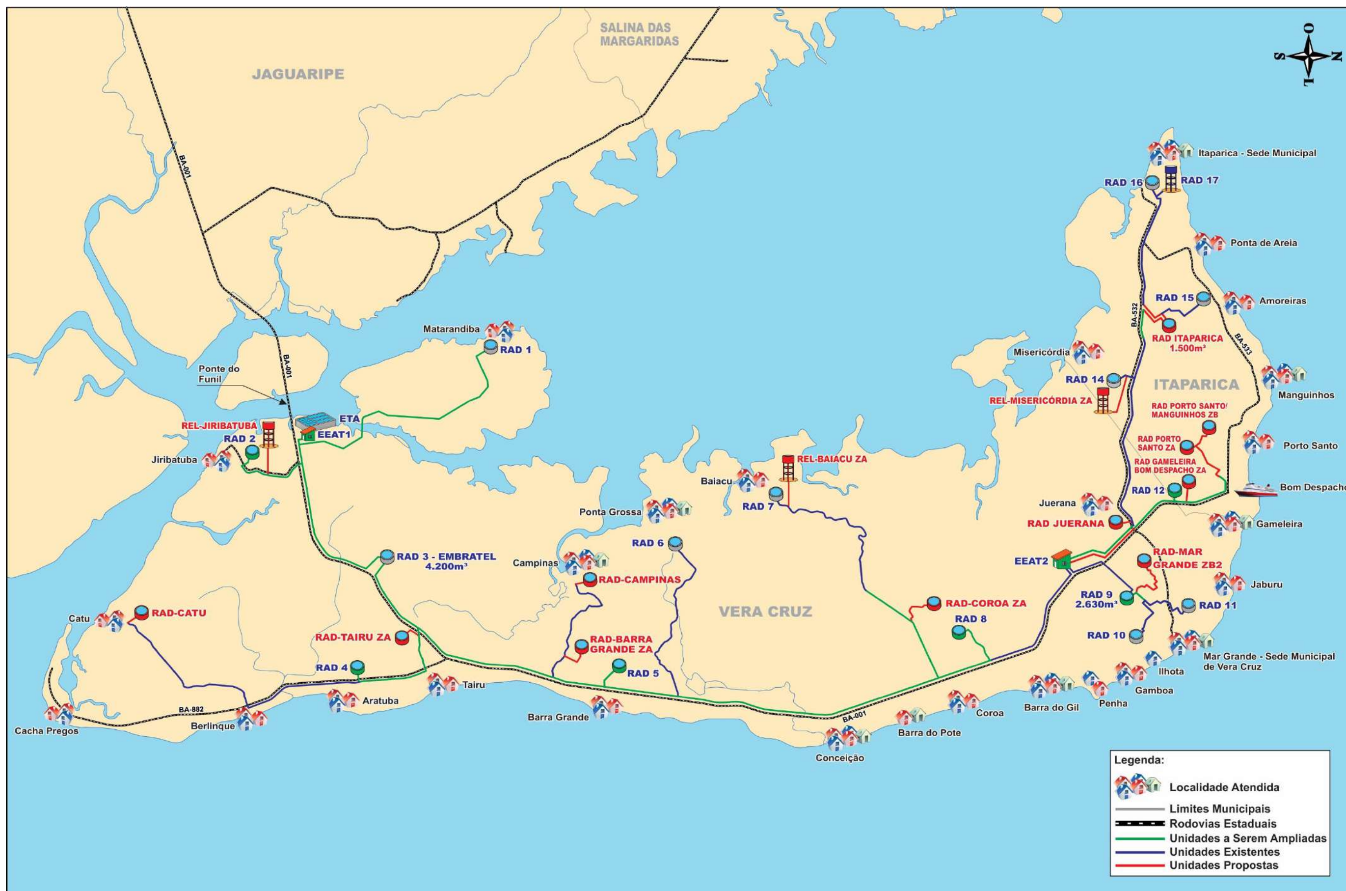
Figura 4.38 – Esquema Geral Simplificado da Alternativa B Sem Ponte do Sistema de Distribuição do SIAA Ilha de Itaparica Elaboração: GEOHIDRO, 2015
