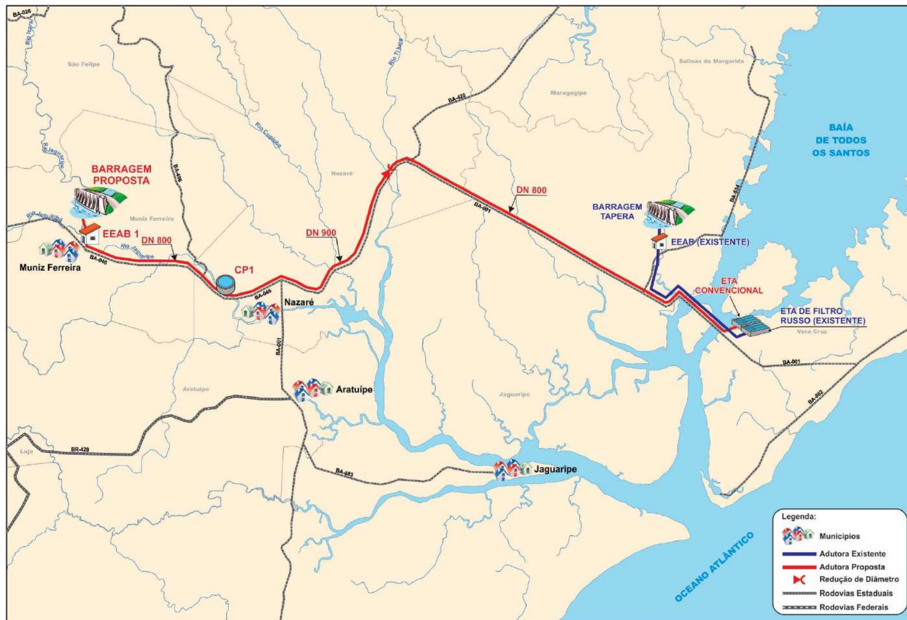
Figura 5.6 – Croqui da concepção do sistema da Alternativa 2 Com Ponte Elaboração: GEOHIDRO, 2015
