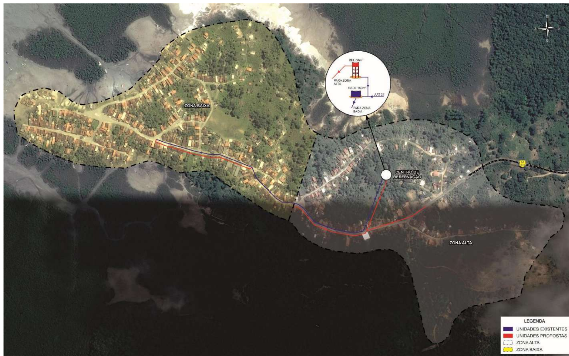
Figura 4.52 – Esquema Geral Proposto da Rede de Abastecimento de Baiacu – Alternativa B Sem Ponte
