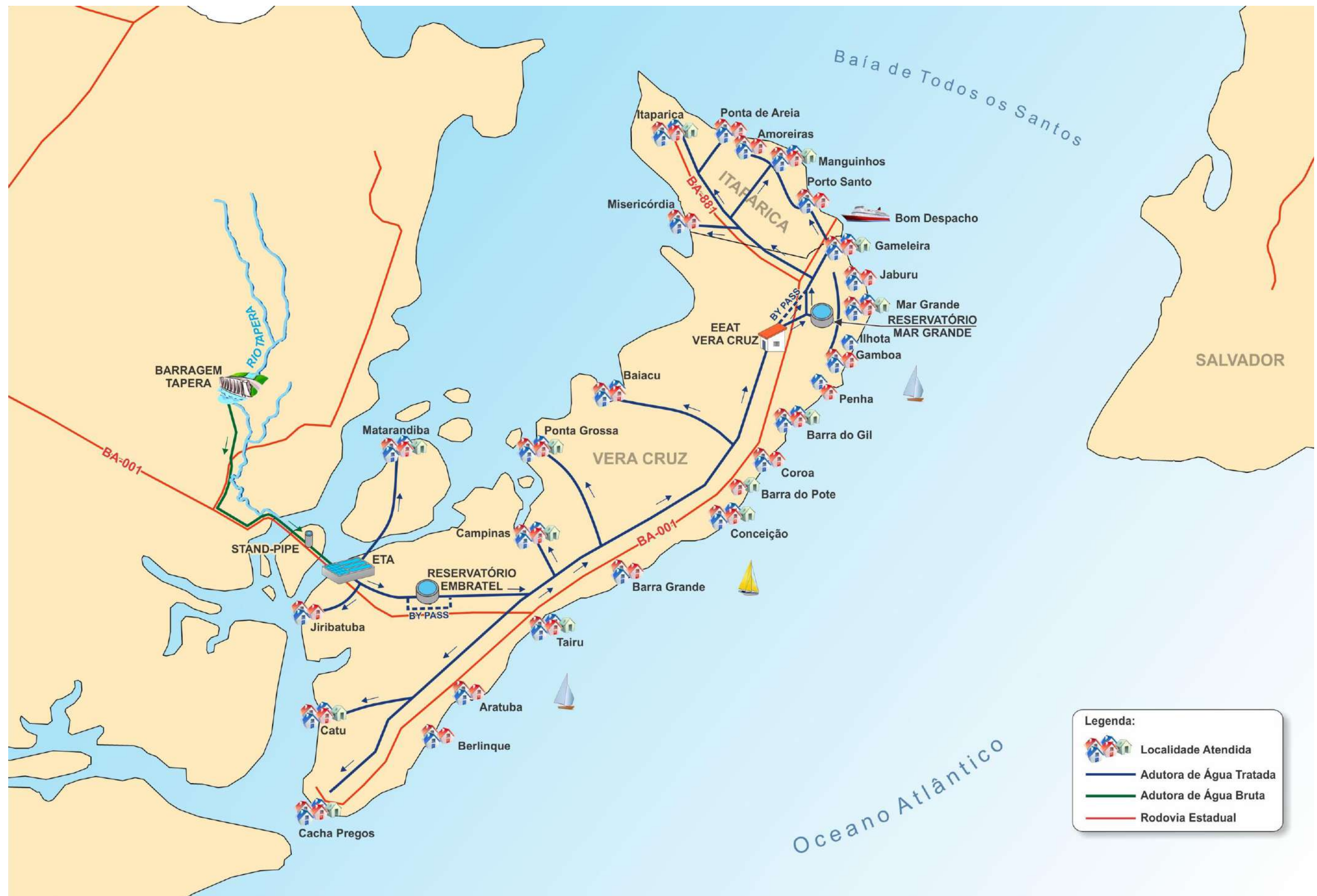
Figura 3.1 - Esquema Geral Simplificado do SIAA Ilha de Itaparica
