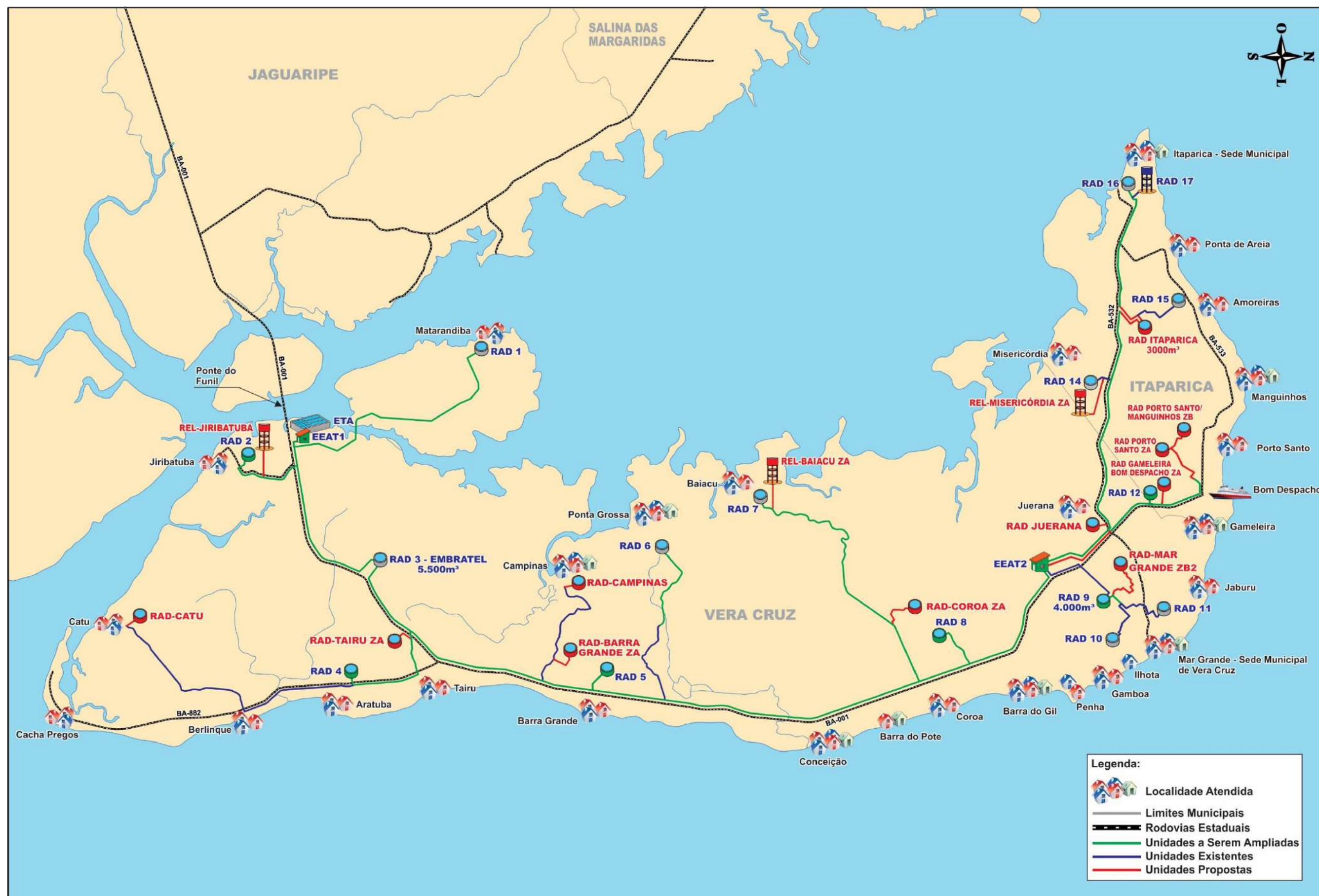
Figura 5.37 – Esquema Geral Simplificado da Alternativa B Com Ponte do Sistema de Distribuição do SIAA Ilha de Itaparica Elaboração: GEOHIDRO, 2015
