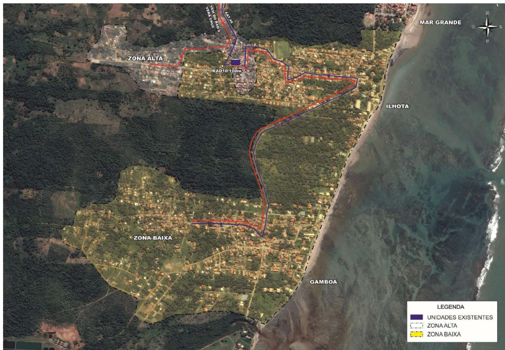
Figura 5.53 – Esquema Geral Proposto da Rede de Abastecimento de Ilhota e Gamboa – Alternativa B Com Ponte
