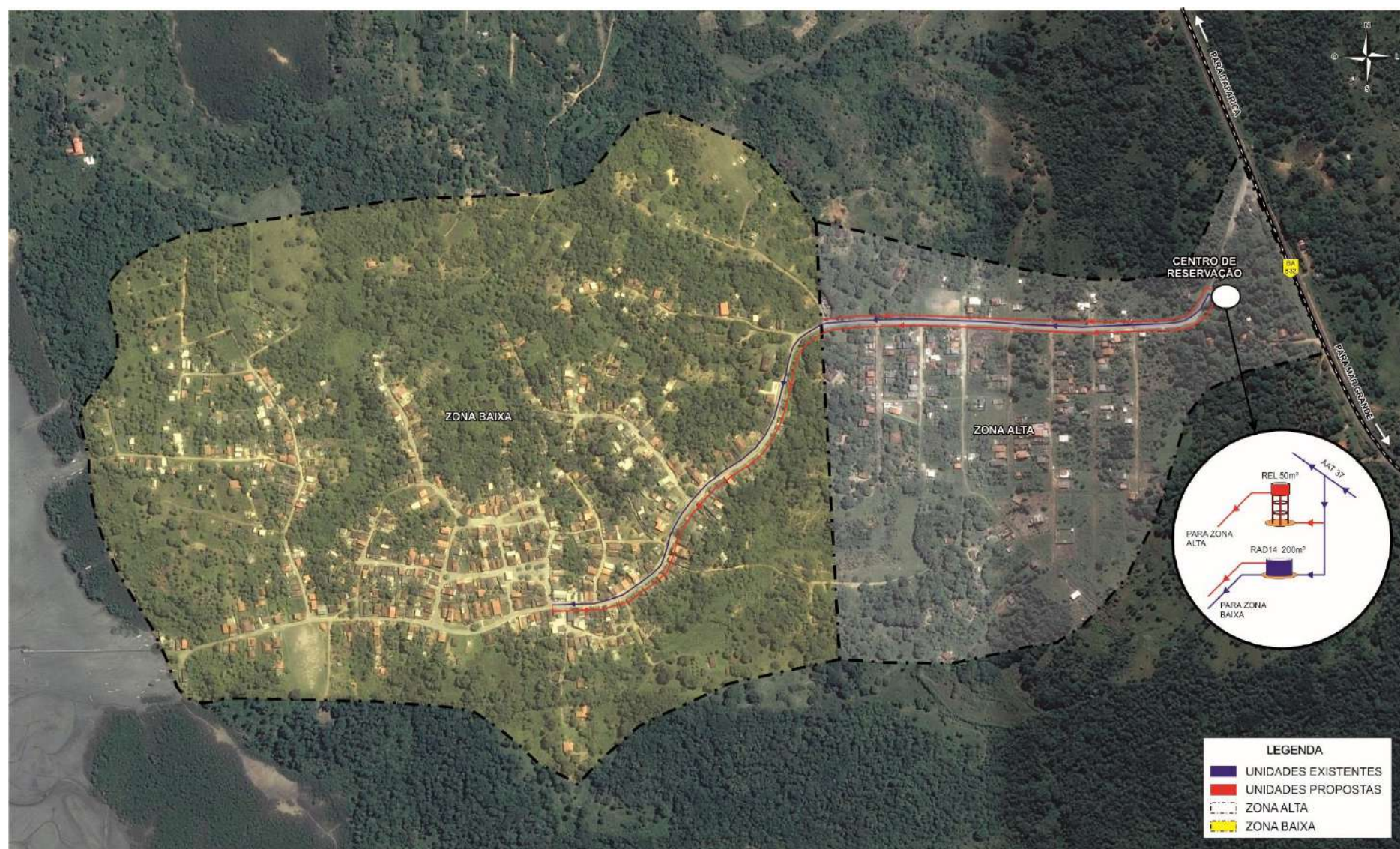
Figura 4.59 – Esquema Geral Proposto da Rede de Misericórdia – Alternativa B Sem Ponte
