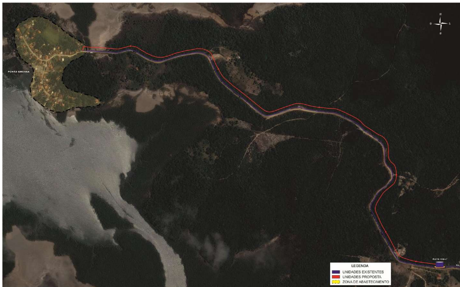
Figura 5.25 – Esquema Geral Proposto da Rede de Abastecimento de Ponta Grossa – Alternativa A Com Ponte
