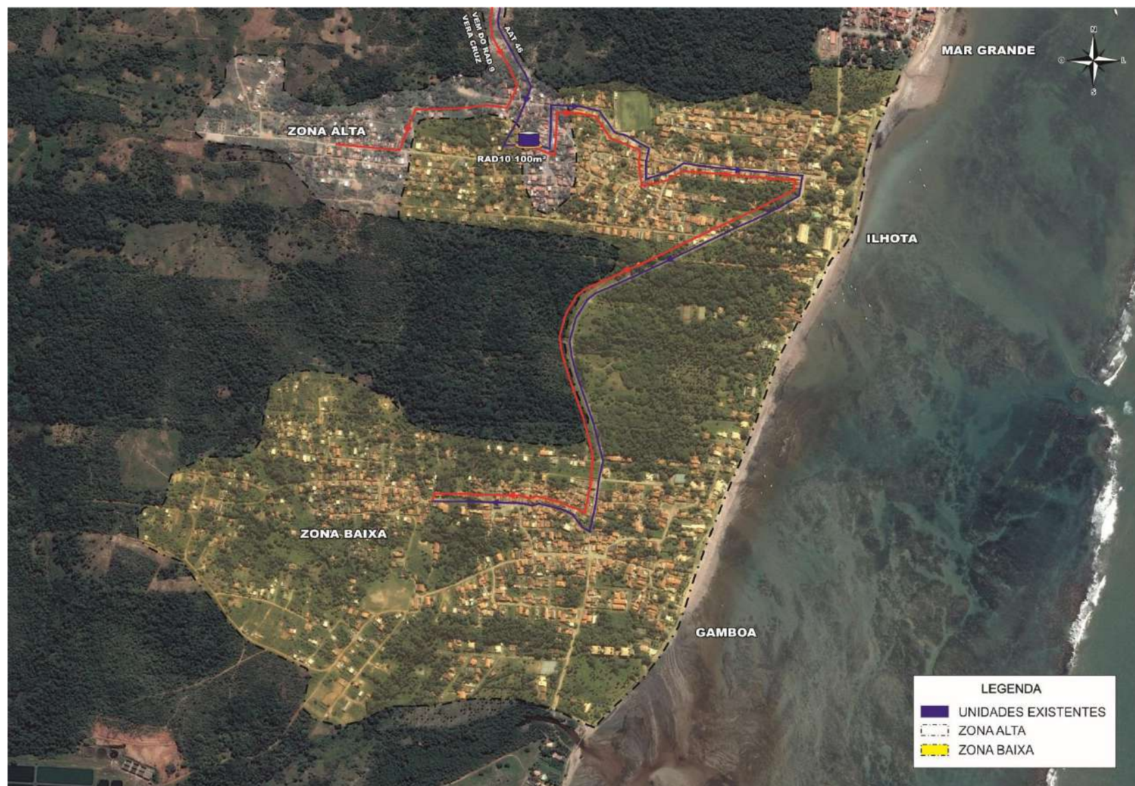
Figura 4.54 – Esquema Geral Proposto da Rede de Abastecimento de Ilhota e Gamboa – Alternativa B Sem Ponte
