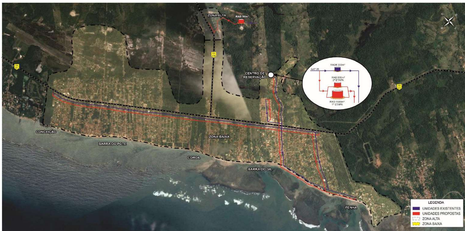
Figura 4.53 – Esquema Geral Proposto da Rede de Abastecimento de Barra do Gil, Barra do Pote, Conceição, Coroa e Penha – Alternativa B Sem Ponte
