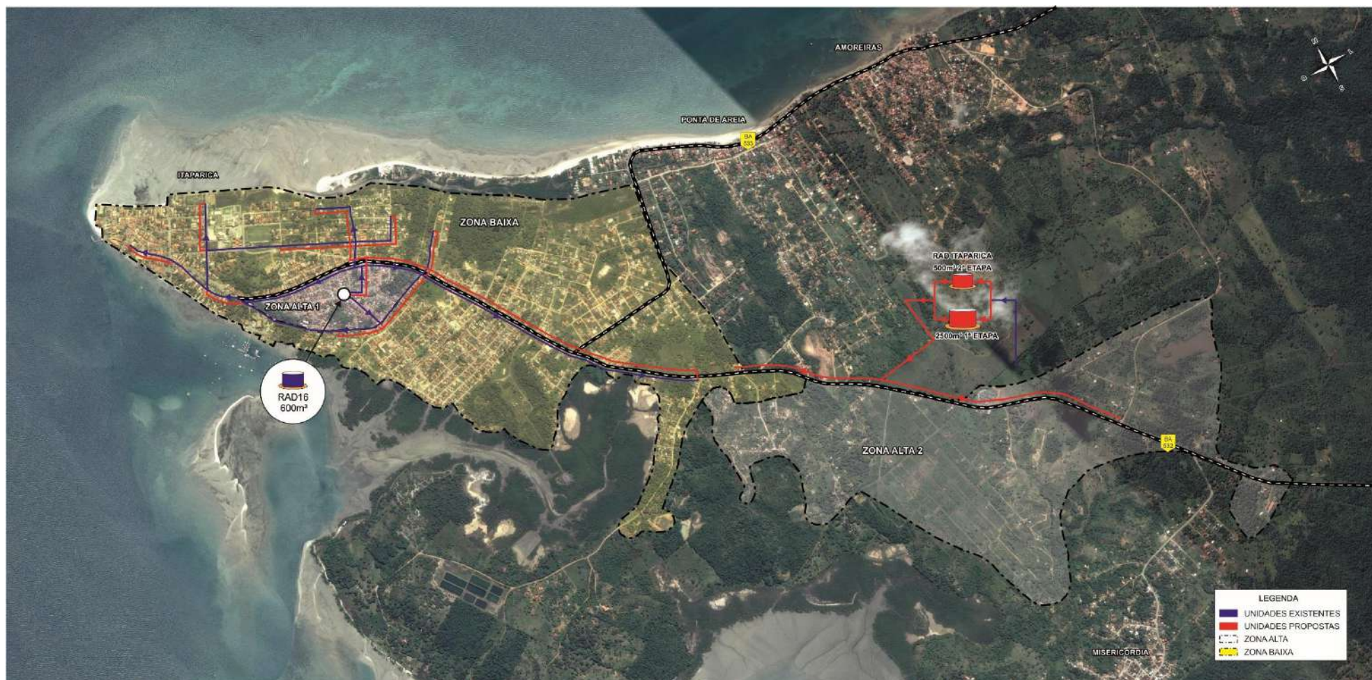
Figura 5.35 – Esquema Geral Proposto da Rede de Itaparica (Zona Baixa e Alta 2) – Alternativa A Com Ponte
