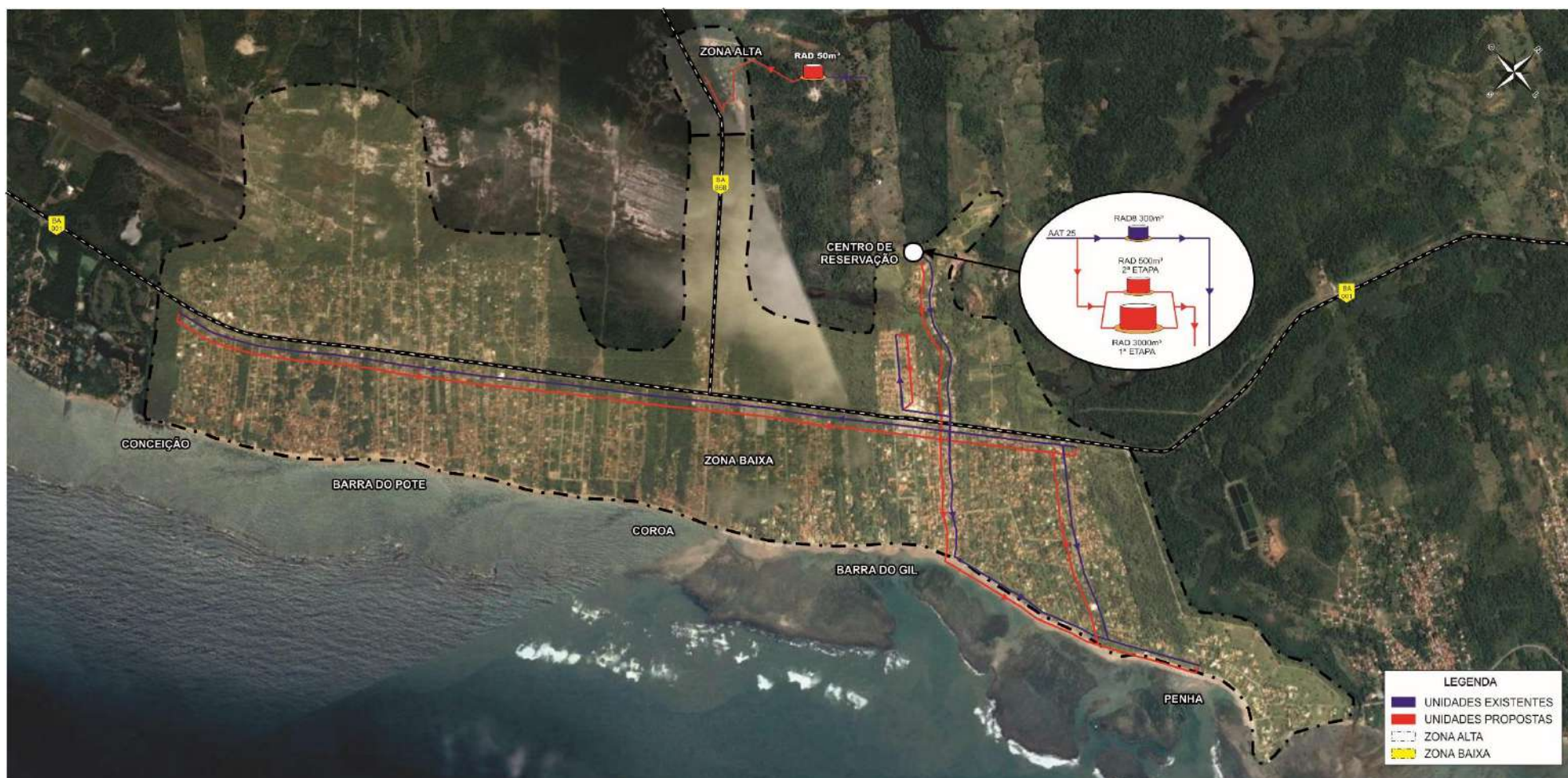
Figura 4.28 – Esquema Geral Proposto da Rede de Abastecimento de Barra do Gil, Barra do Pote, Conceição, Coroa e Penha – Alternativa A Sem Ponte
