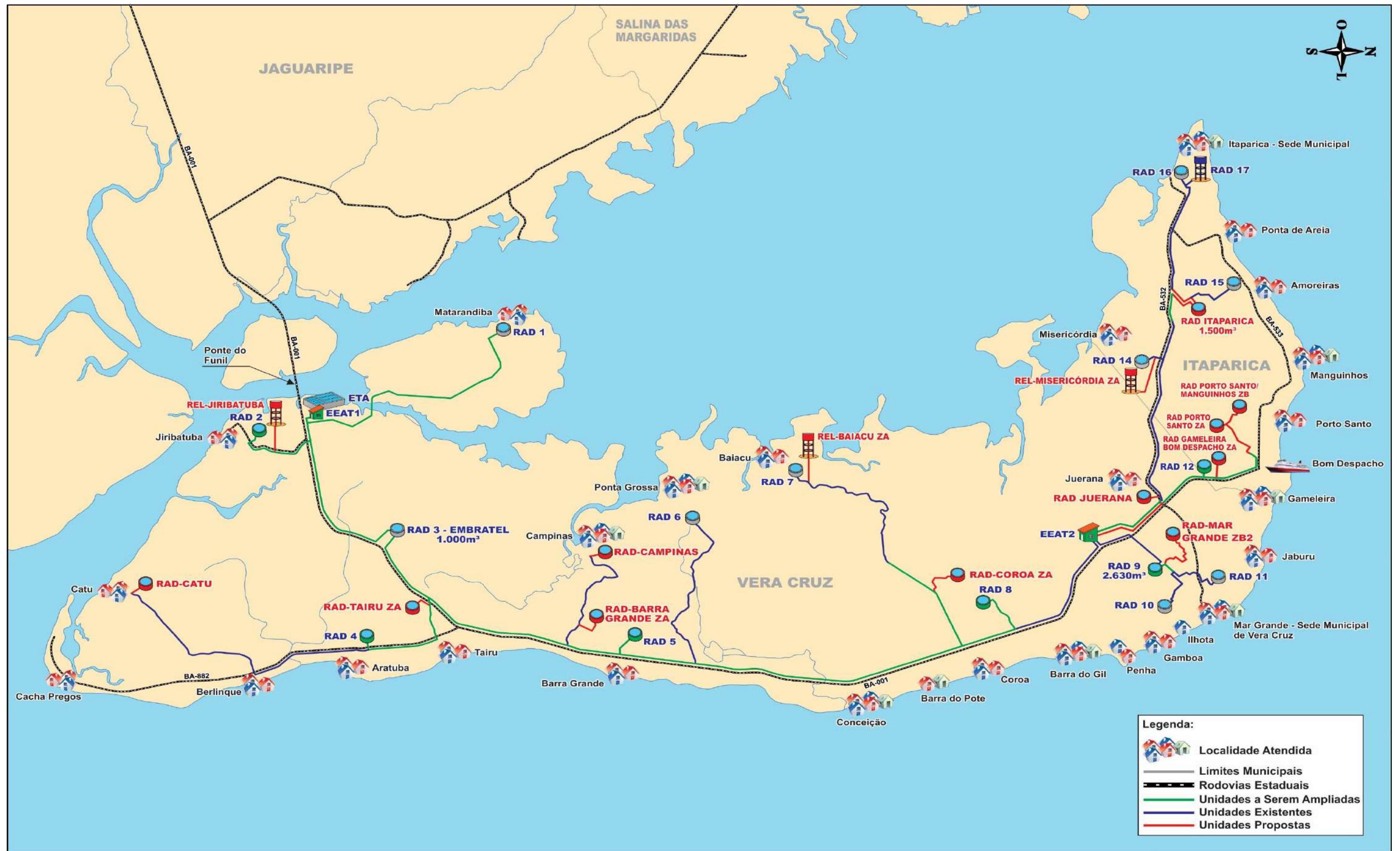
Figura 4.13 - Esquema Geral Simplificado da Alternativa A Sem Ponte do Sistema de Distribuição do SIAA Ilha de Itaparica Elaboração: GEOHIDRO, 2015
