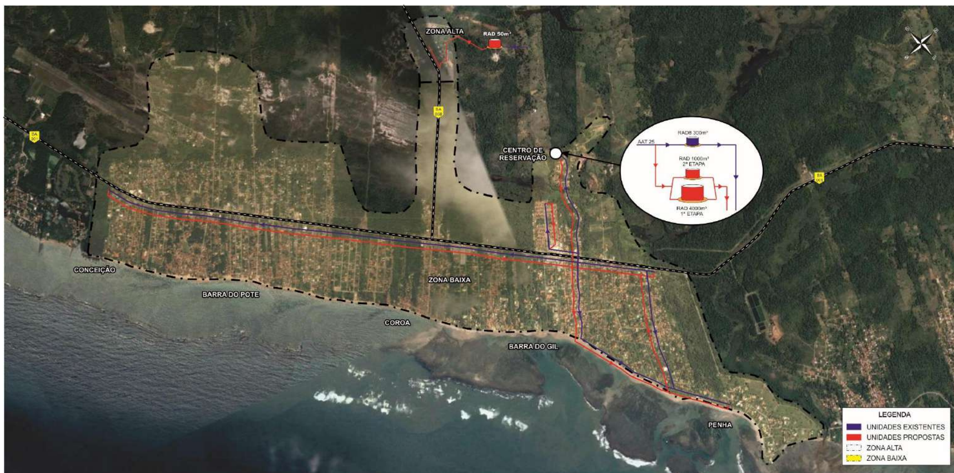
Figura 5.27 – Esquema Geral Proposto da Rede de Abastecimento de Barra do Gil, Barra do Pote, Conceição, Coroa e Penha – Alternativa A Com Ponte
