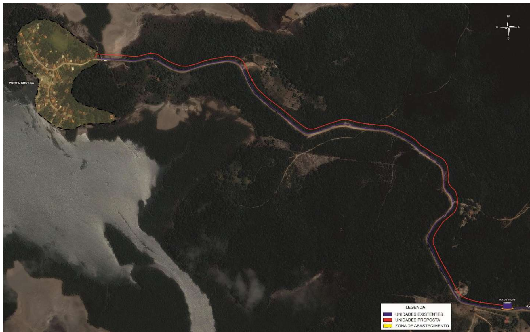
Figura 4.51 – Esquema Geral Proposto da Rede de Abastecimento de Ponta Grossa – Alternativa B Sem Ponte
