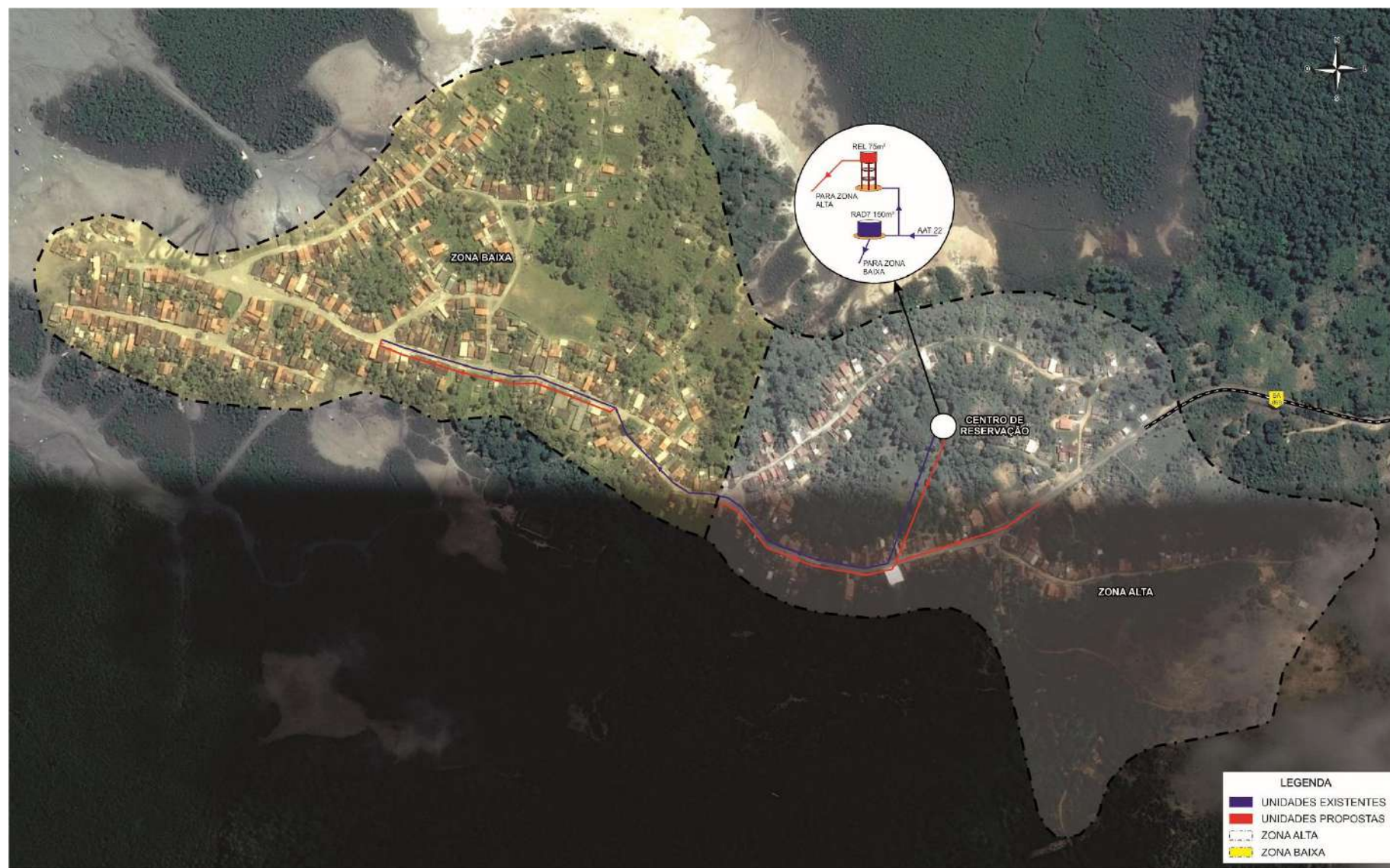
Figura 4.27 – Esquema Geral Proposto da Rede de Abastecimento de Baiacu – Alternativa A Sem Ponte
