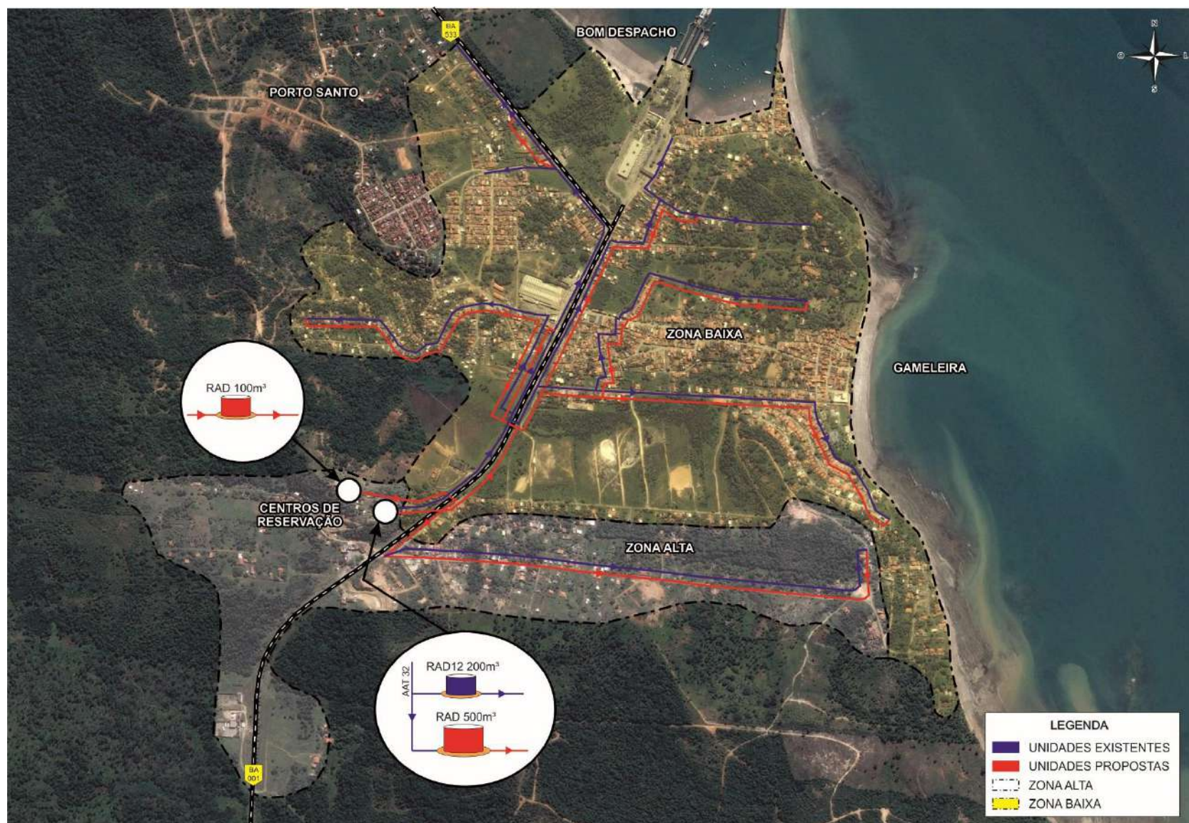
Figura 4.57 – Esquema Geral Proposto da Rede de Gameleira e Bom Despacho – Alternativa B Sem Ponte
