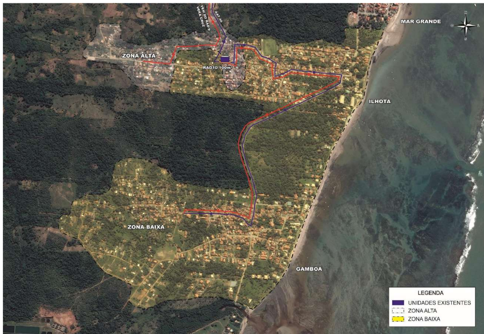
Figura 4.29 – Esquema Geral Proposto da Rede de Abastecimento de Ilhota e Gamboa – Alternativa A Sem Ponte
