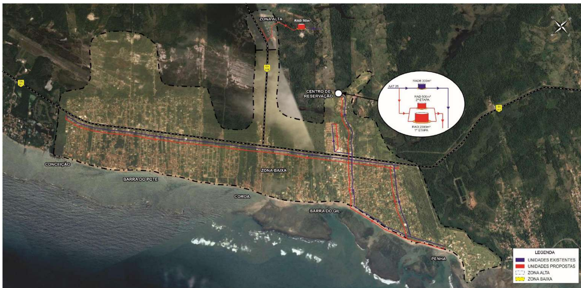
Figura 5.52 – Esquema Geral Proposto da Rede de Abastecimento de Barra do Gil, Barra do Pote, Conceição, Coroa e Penha – Alternativa B Com Ponte
