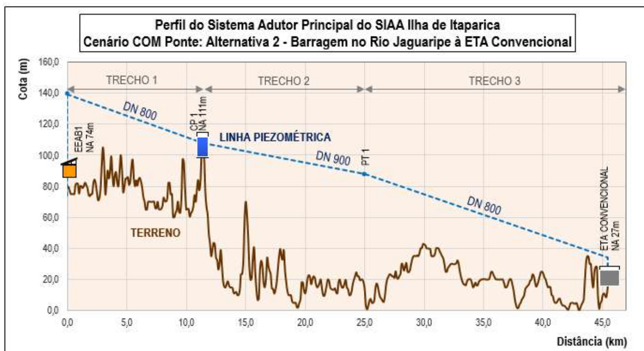
Figura 5.9 – Perfil do Sistema Adutor Principal do SIAA Ilha de Itaparica Alternativa 2 Com Ponte Elaboração: GEOHIDRO, 2015
