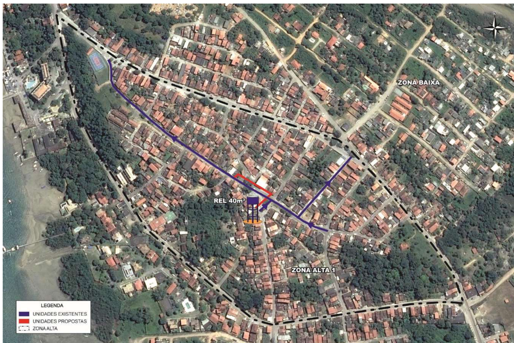
Figura 5.36 – Esquema Geral Proposto da Rede de Itaparica (Zona Alta 1) – Alternativa A Com Ponte
