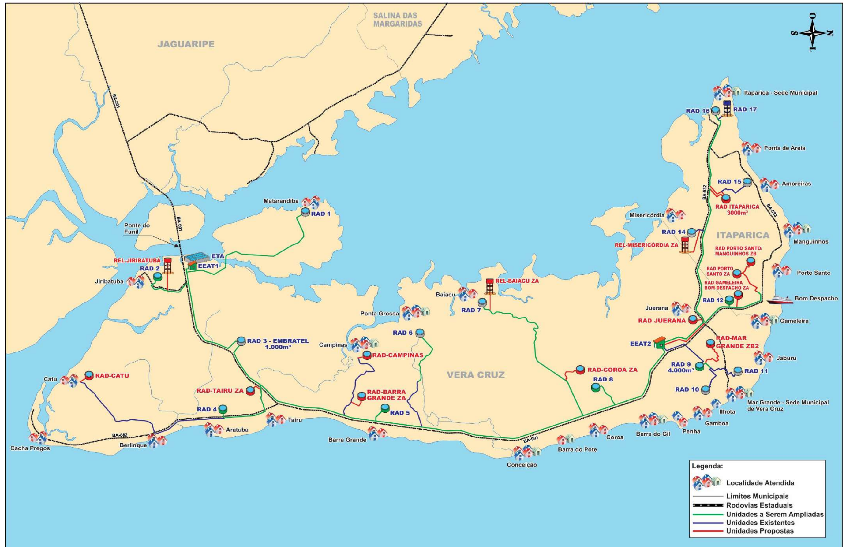
Figura 5.12 - Esquema Geral Simplificado da Alternativa A Com Ponte do Sistema de Distribuição do SIAA Ilha de Itaparica
