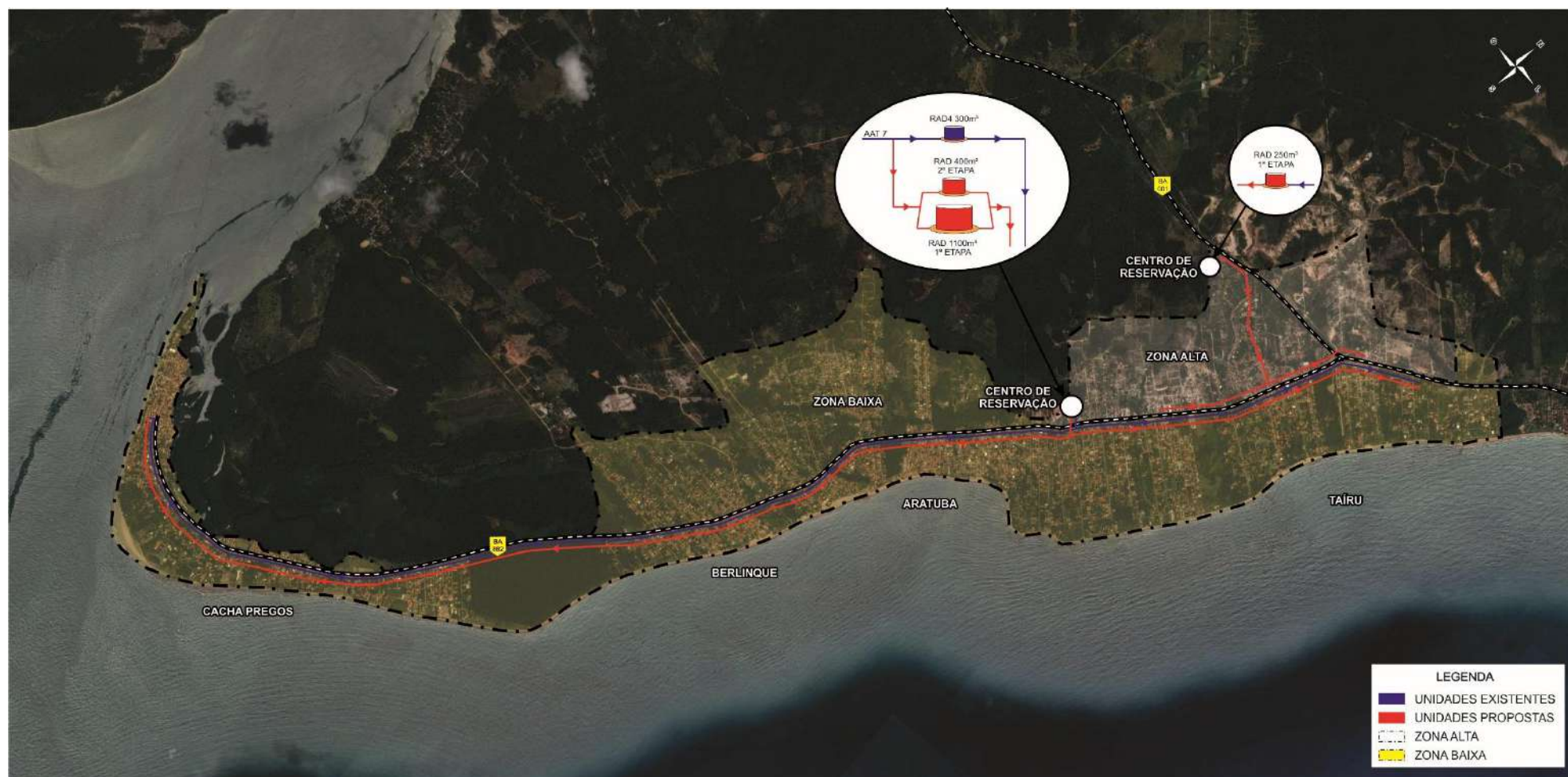
Figura 4.48 – Esquema Geral Proposto da Rede de Abastecimento de Aratuba, Berlinque, Tairú e Cacha Pregos – Alternativa B Sem Ponte
