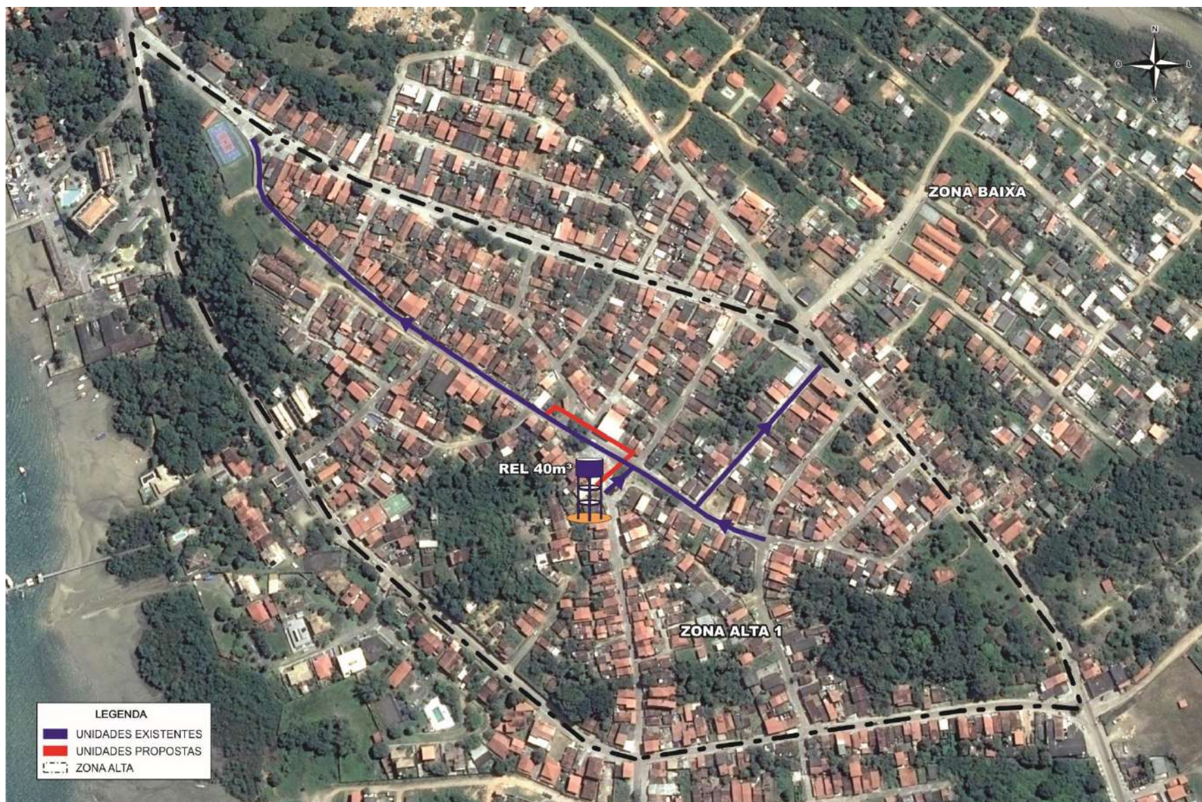
Figura 5.61 – Esquema Geral Proposto da Rede de Itaparica (Zona Alta 1) – Alternativa B Com Ponte
