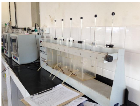
Figura 8.37 – Aparelho de “Jar-test” da ETA, utilizado no ensaio para determinação de concentração de coagulante
