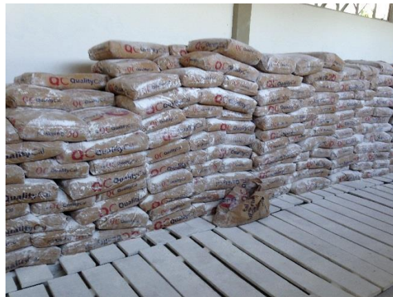
Figura 8.33 – Sacos de hidróxido de cálcio estocados no depósito da ETA
