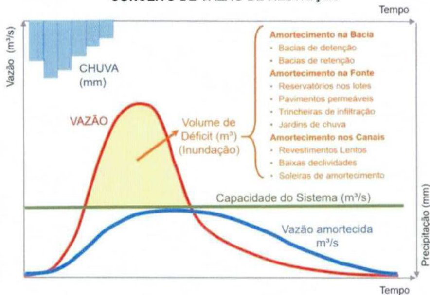
FIGURA 1.32 CONCEITO DE VAZÃO DE RESTRIÇÃO
