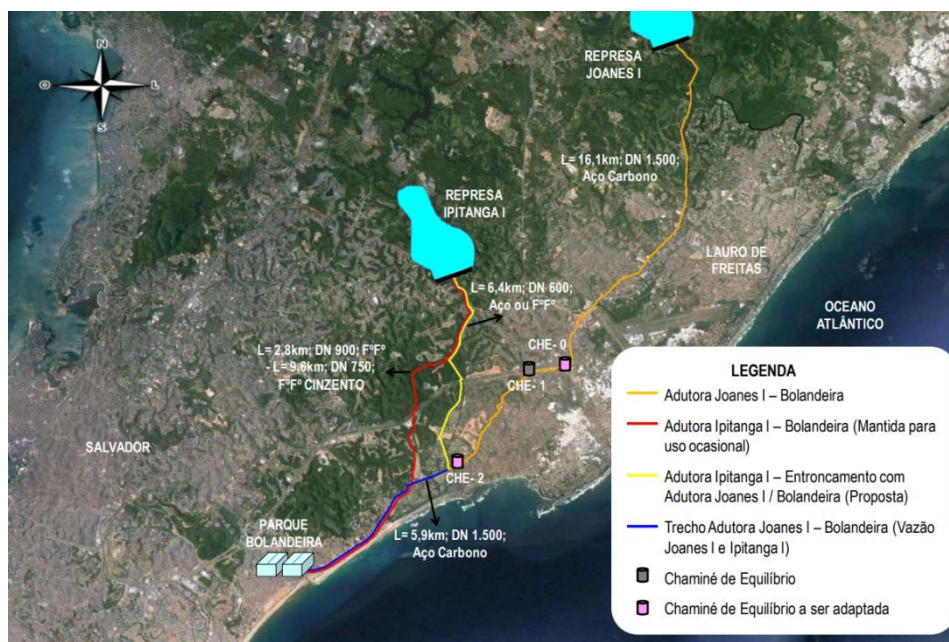
Figura 8 - Solução proposta para o Sistema Adutor de Água Bruta do Parque da Bolandeira Fonte: PARMS (2016).
