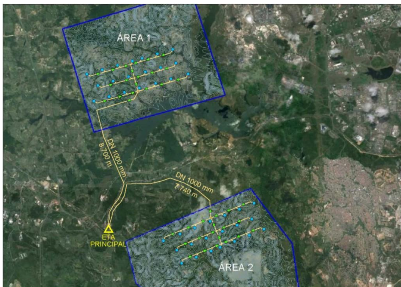
Figura 1.4 - Captação de água subterrânea e adução para a ETA Principal
