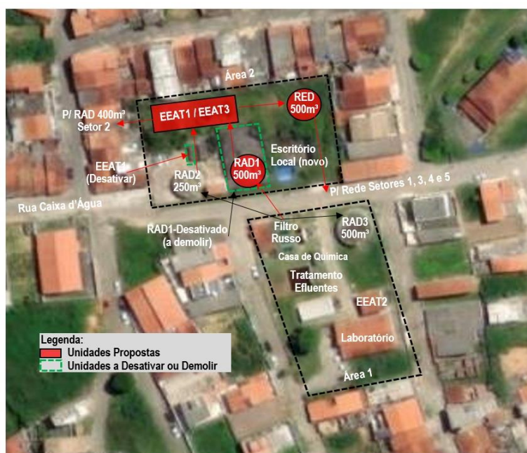
Figura 8.5 - Área de Tratamento e Reservação do SAA Sede São Sebastião do Passé Fonte: Google Earth (2024).
